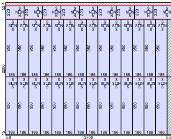
FIGURA 16 – PADRÕES DE CORTE CHAPA 15MM X 2200MM CONTINUAÇÃO.
