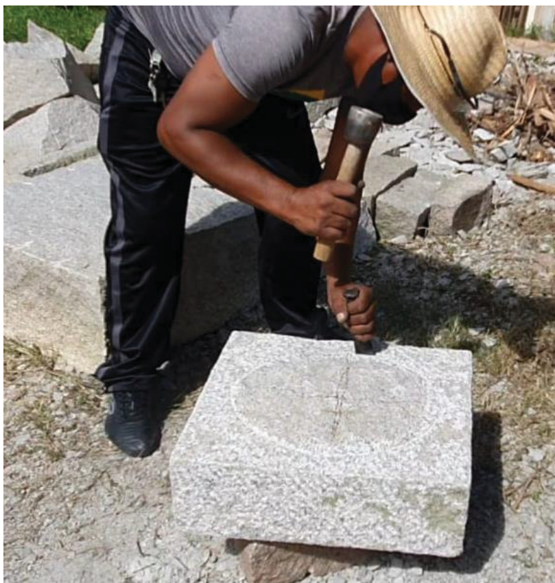
FIGURA 25 – DEMONSTRAÇÃO DA CONSTRUÇÃO DA ELIPSE
