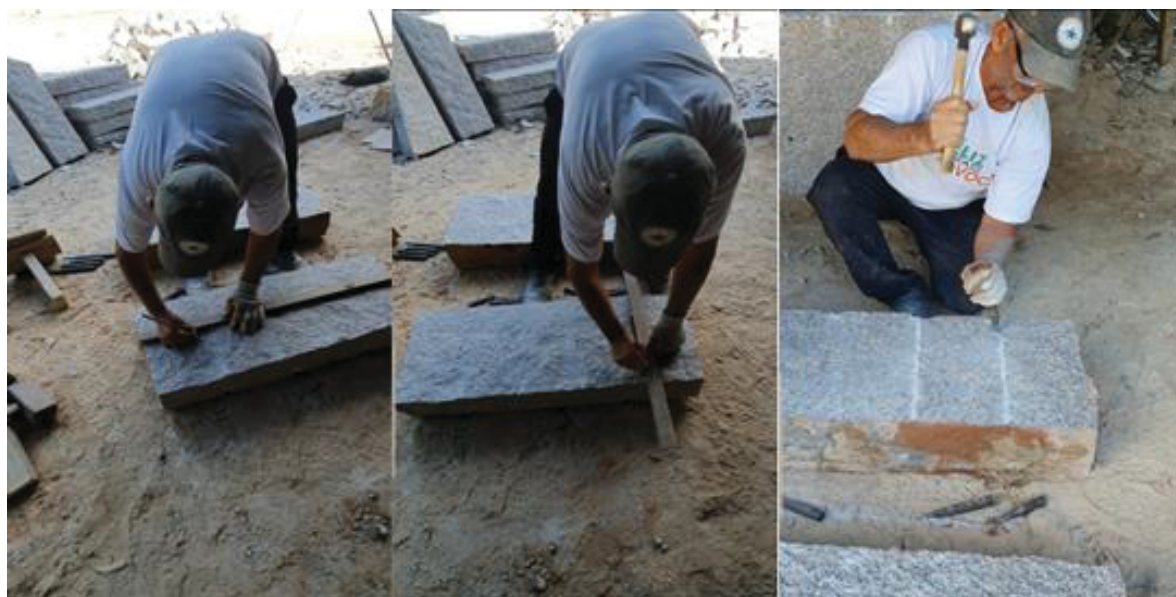
FIGURA 21 – LUIZ MEDINDO E DIVIDINDO A PEDRA
