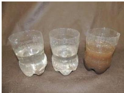
FIGURA 22. Resultado do experimento da erosão hídrica, mostrando a perda de erosão no solo com cobertura viva (esquerda), morta (centro) e sem cobertura (direita). Fotos: Marcelo Ricardo de Lima.
