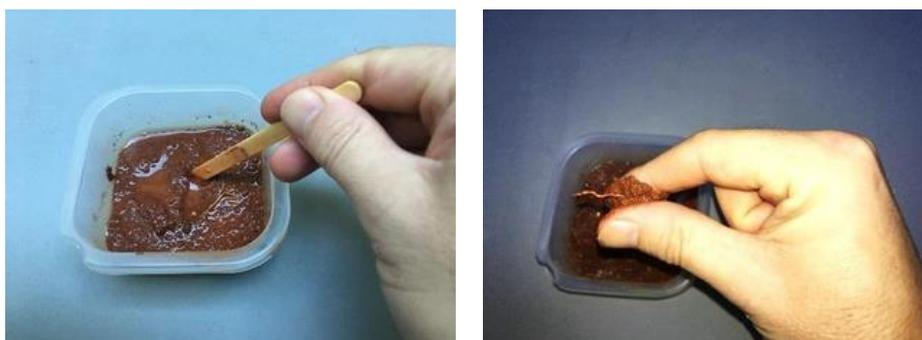
**FIGURA 12.** Preparação da amostra de solo (esquerda) e determinação da textura esfregando o solo úmido entre os dedos indicador e polegar (direita). Fotos: Marcelo Ricardo de Lima.
