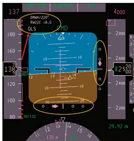
FIGURA 28 – TELA DE VOO INDICANDO APROXIMAÇÃO POR GLS
