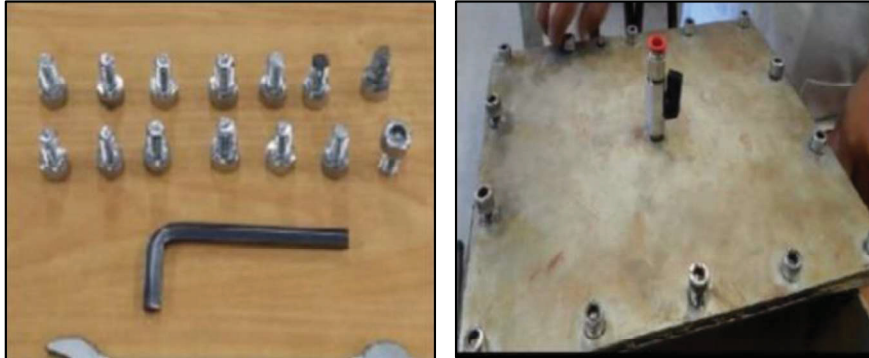
Figura 58 – Ferramentas usadas no fechamento da tampa da caixa de arrancamento
