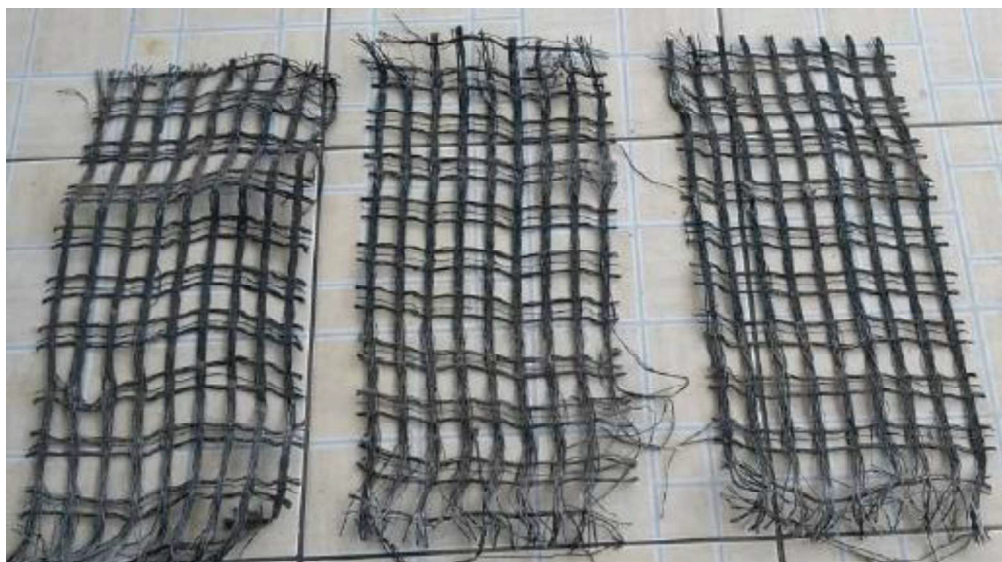
Figura 62 - Geogrelhas utilizadas para melhoria da garra e calibragem das medidas internas
