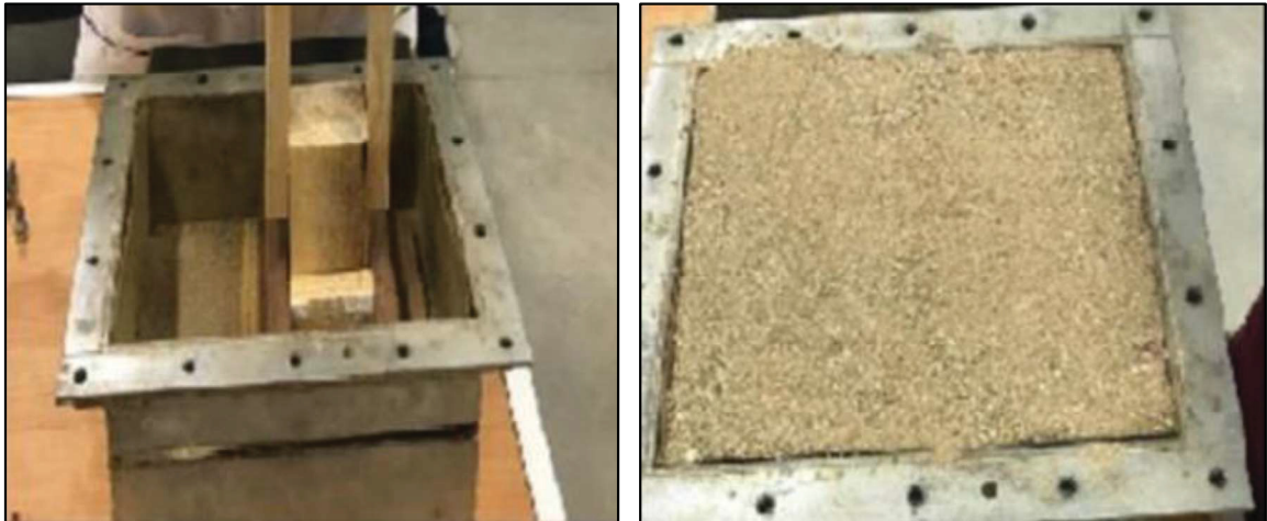
Figura 56 - Compactação manual e preenchimento até a borda do equipamento de arrancamento
