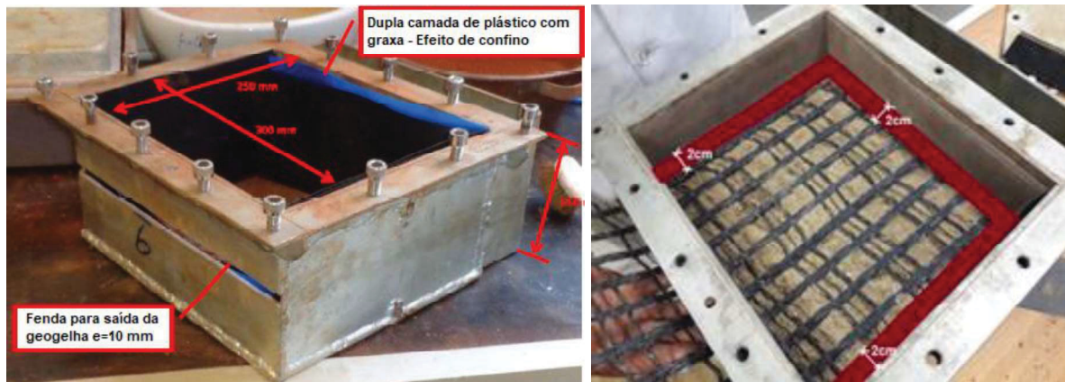
Figura 57 - Ações para minimizar efeito de confinamento lateral na caixa de arrancamento
