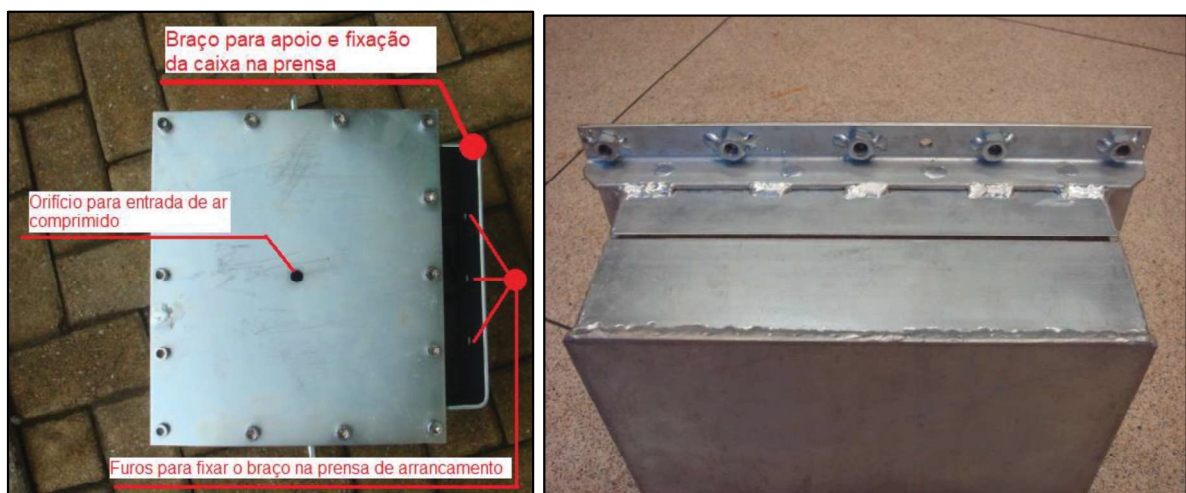
Figura 49 - Vista superior da caixa e detalhe das porcas soldadas na parte inferior da borda
