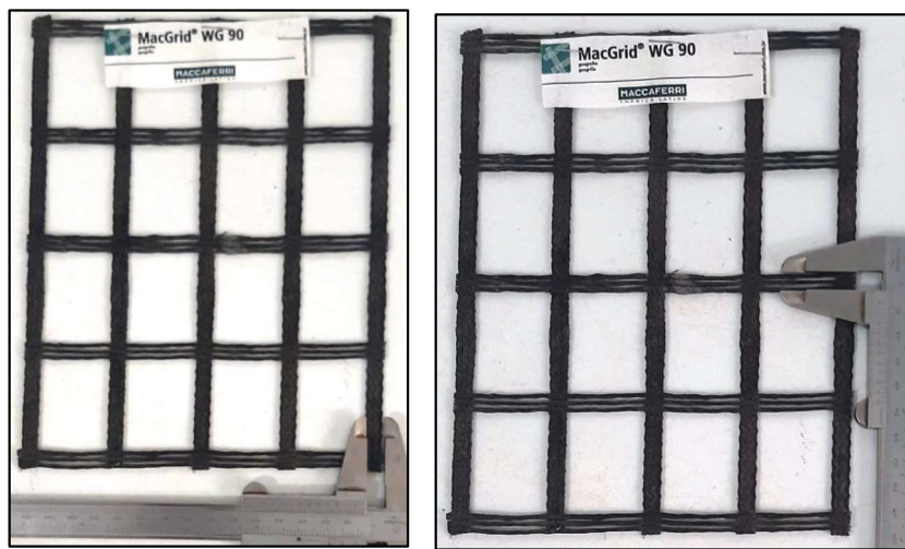
Figura 47 - Medidas de espessuras em elementos longitudinais e transversais
