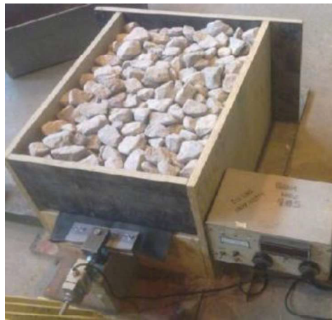
Figura 21 - Teste de arrancamento em equipamento de pequeno porte com material granular
