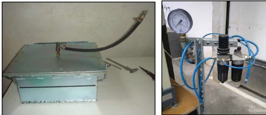
Figura 59 - Encaixe da mangueira na tampa e passagem do ar pelo estabilizador de pressão
