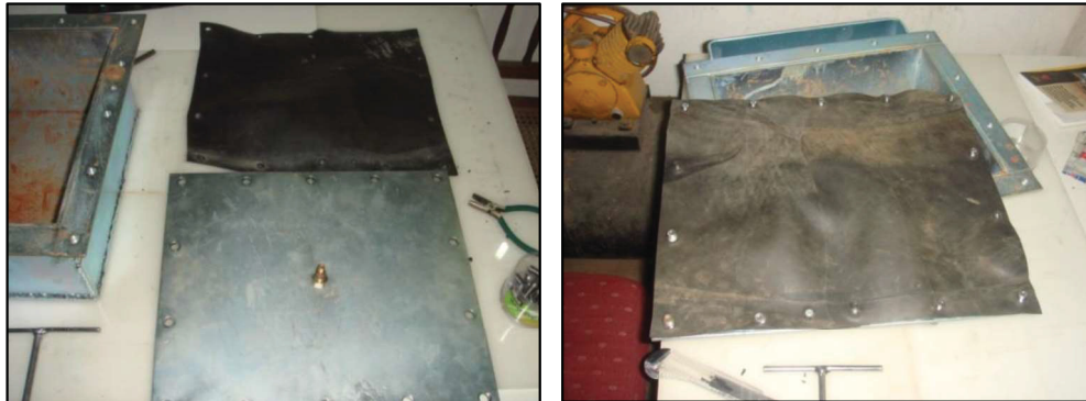
Figura 54 - Placa de borracha instalada para formar o bolsão de ar comprimido
