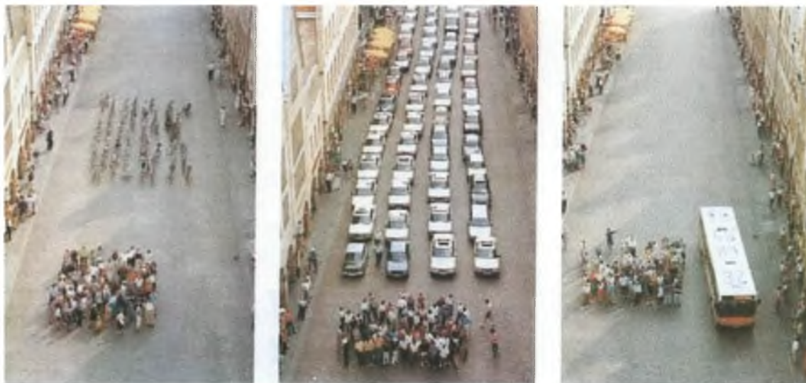
FIGURA 29 – ESPAÇO VIÁRIO OCUPADO PELO MESMO NÚMERO DE PESSOAS EM 3 MODAIS DIFERENTES: BICICLETA, CARRO E ÔNIBUS.
