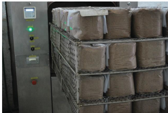
FIGURA 3 - AUTOCLAVAGEM DOS BLOCOS PARA CULTIVO.
