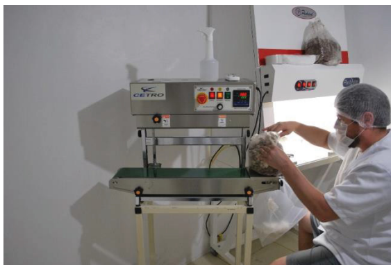
FIGURA 5 - INOCULAÇÃO E FECHAMENTO DOS BLOCOS AXÊNICOS PARA TRANSPORTE.
