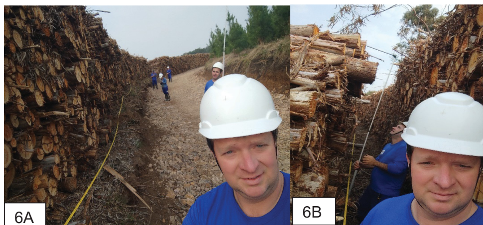
Figuras 6. Medição do volume das pilhas de lenha de E. benthamii , com auxílio de fita métrica(6A), e régua telescópica (6B) para determinação do volume em metro estéreo.
