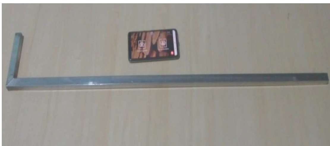
Figura 8. Bastão e smartphone com aplicativo TIMBETER instalado.
