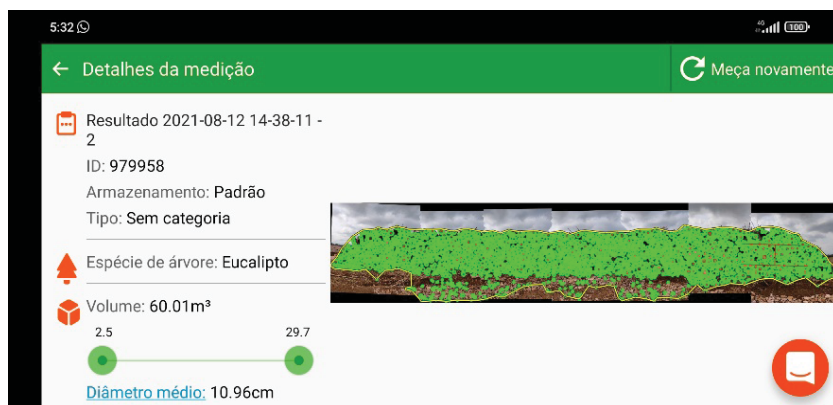
Figura 9. Resultado da captura de imagens de uma pilha de lenha com aplicativo TIMBETER.
