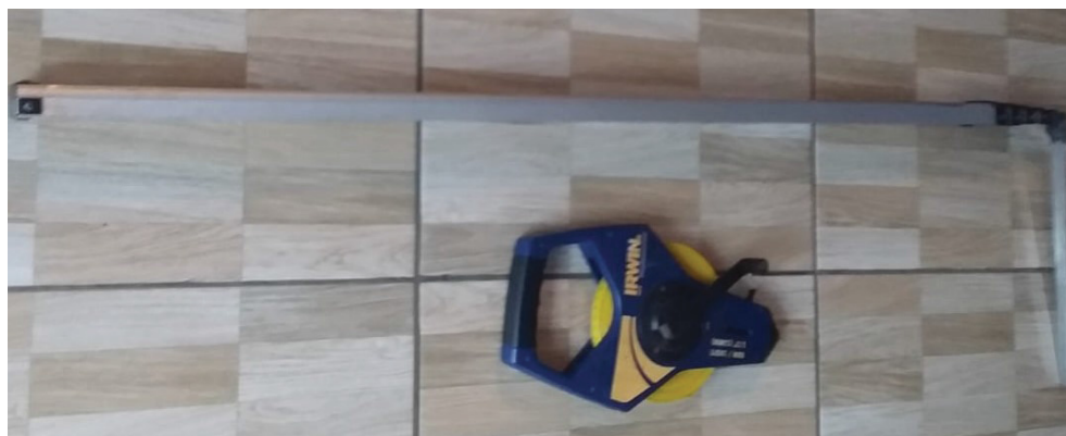
Figura 5. Régua telescópica e fita métrica (trena) de 50 m utilizada na mensuração da lenha.
