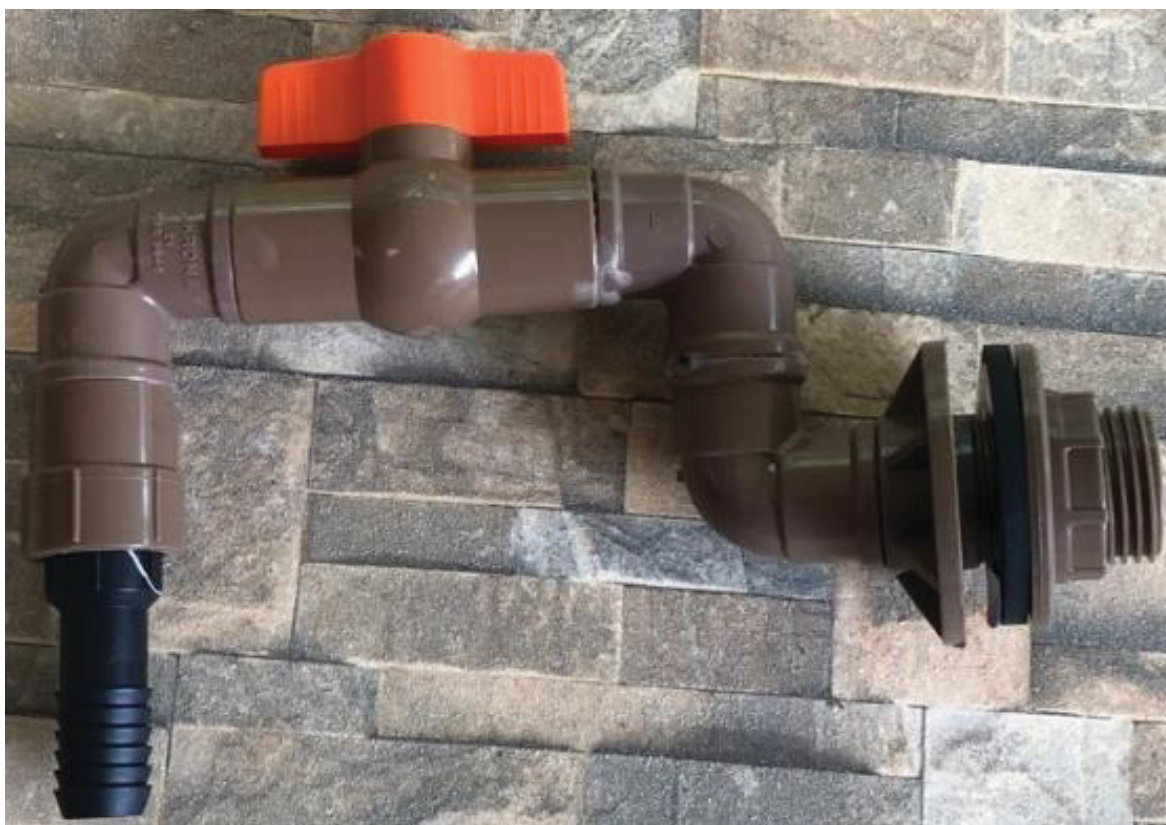
FIGURA 03 - Detalhe da conexão em “u” invertido
