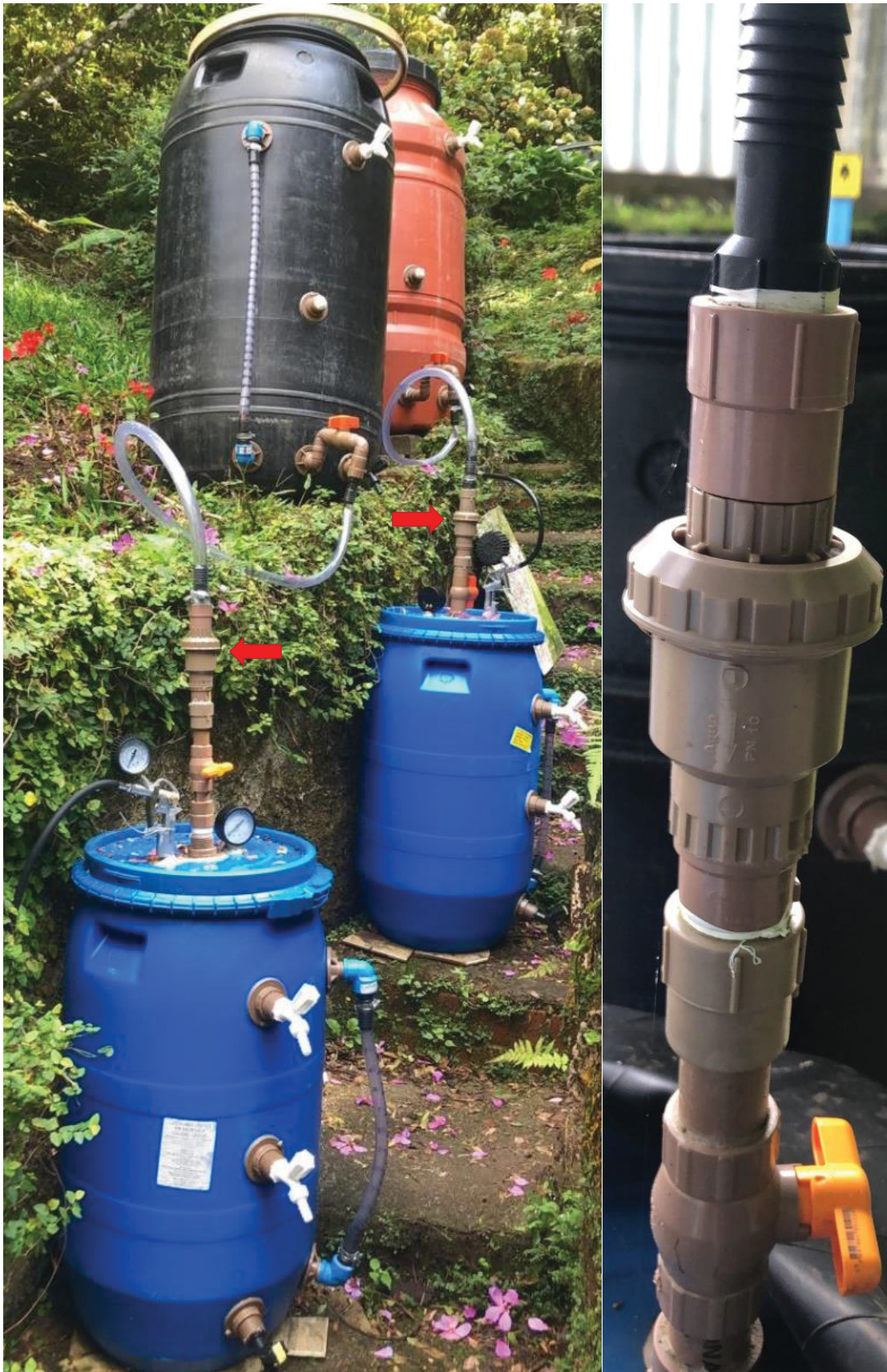
FIGURA 44 - Dois protótipos indicando a utilização de válvula de retenção unidirecional como separação eficiente entre composteiras aeróbios e biodigestores anaeróbios
