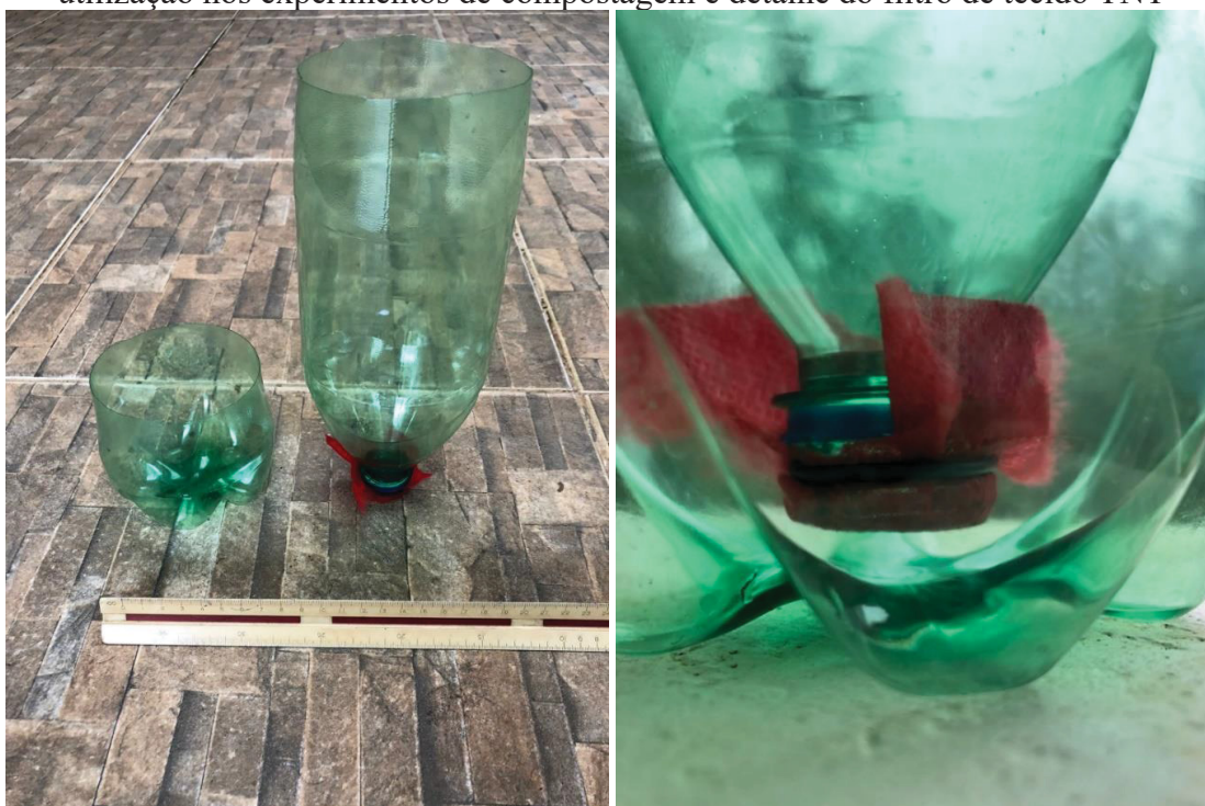
FIGURA 1 - Fotografia demonstrando a localização sugerida da secção nas garrafas pet para utilização nos experimentos de compostagem e detalhe do filtro de tecido TNT
