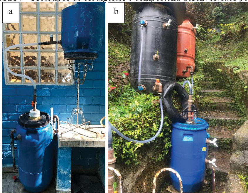
FIGURA 7 - Protótipos de biodigestor e composteira desenvolvidos pelo autor
