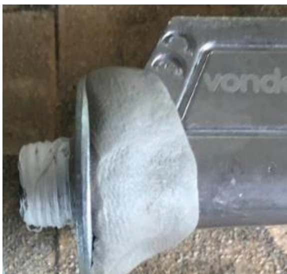
FIGURA 43 - Detalhe da adaptação do calibrador de pneus analógico à tampa do biodigestor
