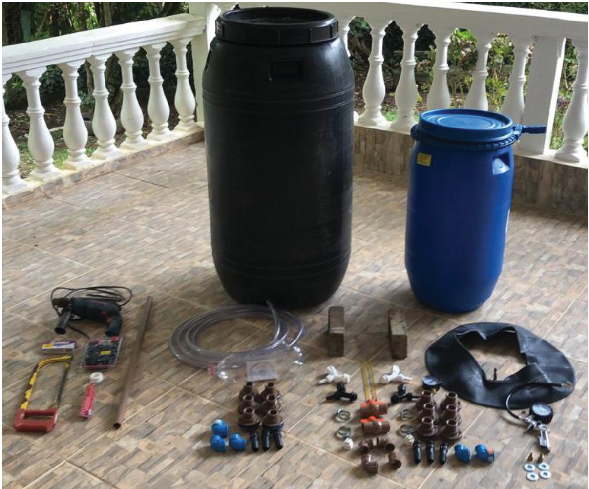
Ferramentas e materiais necessários para construção de uma composteira unida a um biodigestor anaeróbio. FONTE: O autor (2022).
