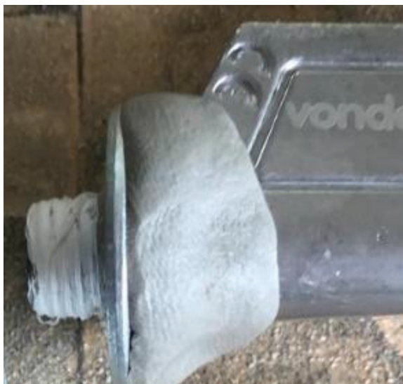
FIGURA 06 - Detalhe da adaptação do calibrador de pneus analógico à tampa do biodigestor
