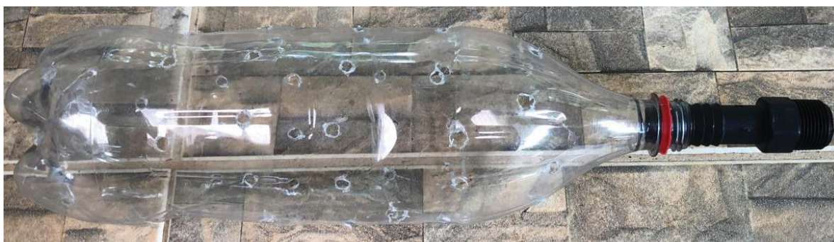
FIGURA 04 - Filtro simples para compostos sólidos provenientes da composteira
