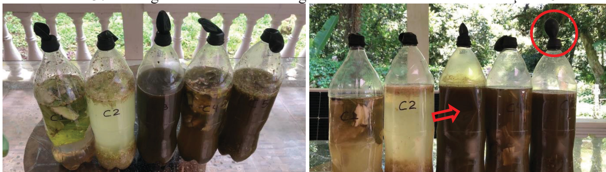
FIGURA 37 - Fotografia da série de biodigestão anaeróbia em uma diferença de 8 dias
