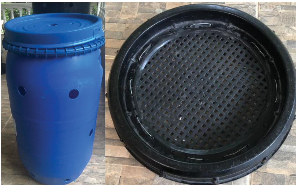
FIGURA 39 - Locais de furações das bombonas com o serra-copos e adequação de materiais em bombonas de 200 litros para a confecção de tampas teladas para a composteira
