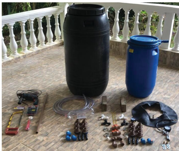
FIGURA 01 - Materiais necessários para a construção de uma composteira aeróbia aliada a um biodigestor anaeróbio
