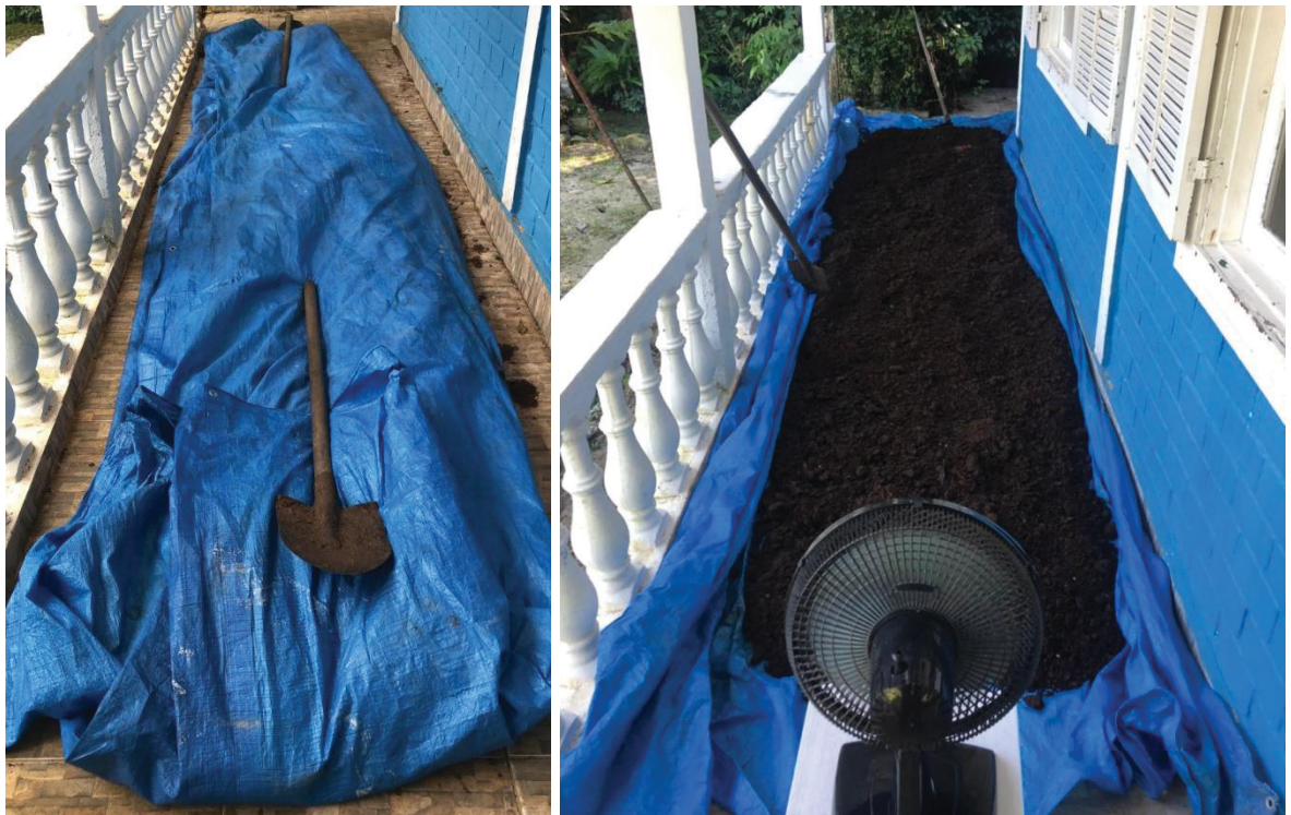
FIGURA 16 - Fotografias do processo de secagem com ventilação forçada em área coberta
