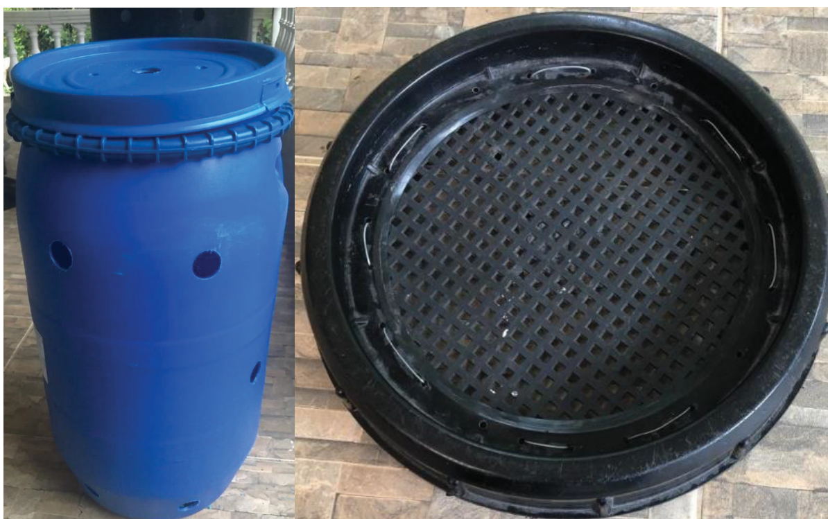
FIGURA 02 - À direita, locais de furações das bombonas com o serra-copos, à esquerda, adequação de materiais em bombonas de 200 litros para a confecção de tampas teladas para a composteira
