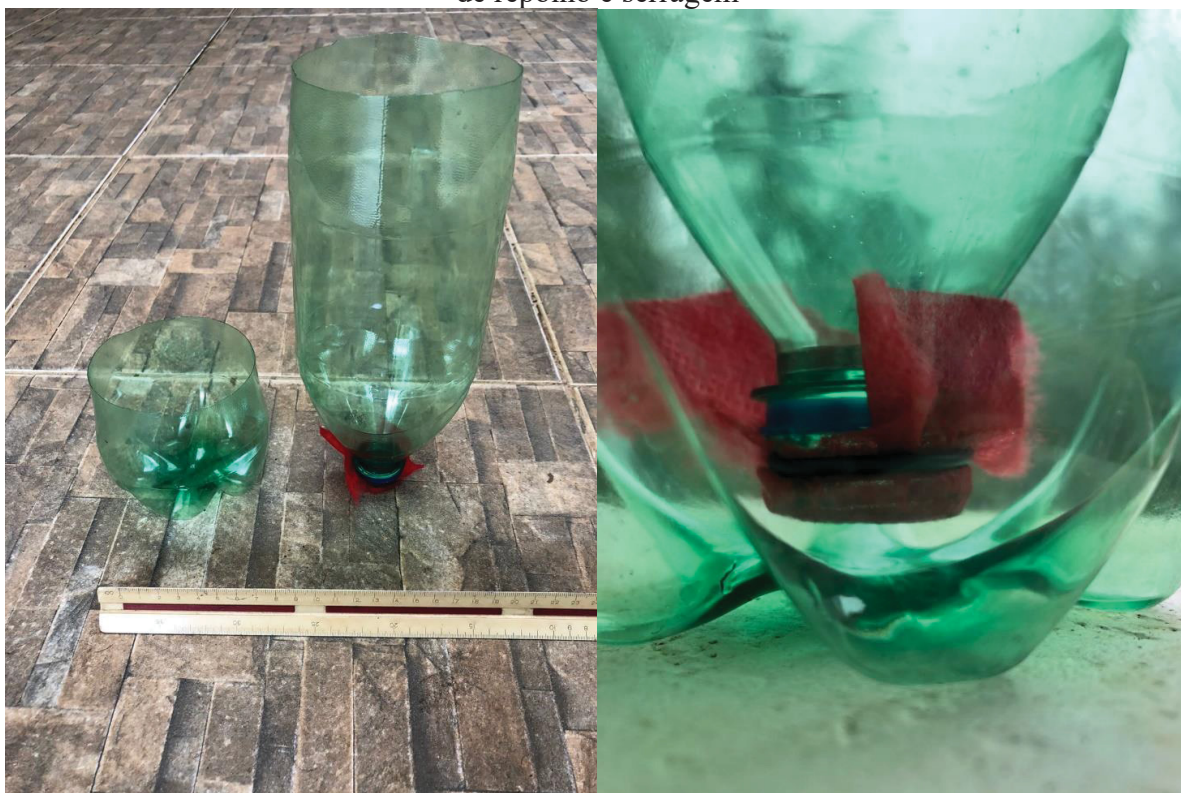
FIGURA 22 - Garrafas PET para utilização nos experimentos de compostagem com resíduo de repolho e serragem
