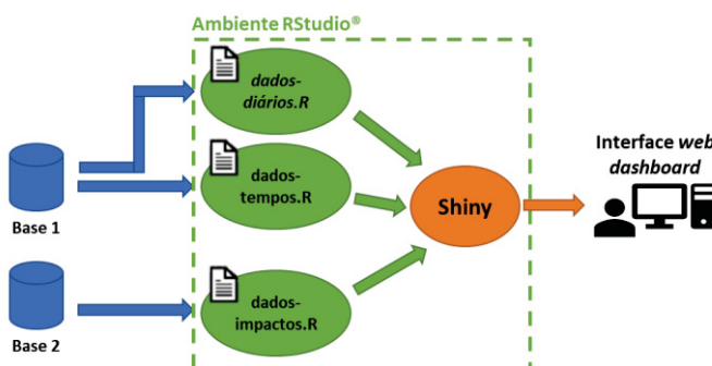
Figura 3: Esquema para o fluxo de informações entre as bases, os arquivos em R e o pacote Shiny para gerar o dashboard .
