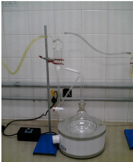
FIGURA 8 - EXTRATOR DE ÓLEO ESSENCIAL DE BANCADA: CONJUNTO DE MANTA AQUECEDORA, BALÃO VOLUMÉTRICO, APARELHO GRADUADO DE CLEVINGER E SERPENTINA RESFRIADORA. LABORATÓRIO DE ECOFISIOLOGIA, SETOR DE CIÊNCIAS AGRÁRIAS, UFPR, 2008.
