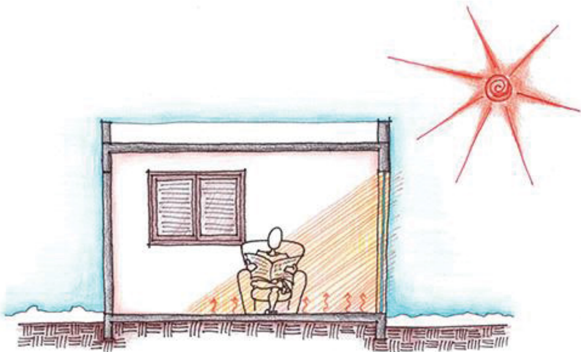
FIGURA 56 - DESENHO ESQUEMÁTICO REPRESENTANDO O AQUECIMENTO SOLAR PASSIVO
