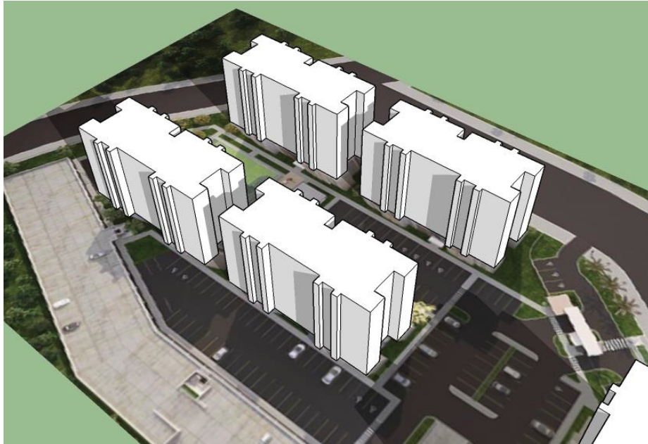
FIGURA 41 - INCIDÊNCIA SOLAR: FACHADAS NORTE-OESTE NO SOLSTÍCIO DE INVERNO 15h
