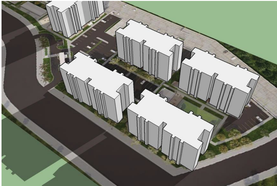
FIGURA 38 - INCIDÊNCIA SOLAR: FACHADAS SUL-LESTE NO SOLSTÍCIO DE INVERNO 9h
