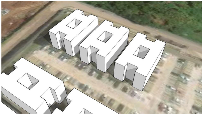
FIGURA 25 - INCIDÊNCIA SOLAR: FACHADAS SUL-LESTE NO SOLSTÍCIO E VERÃO 9h
