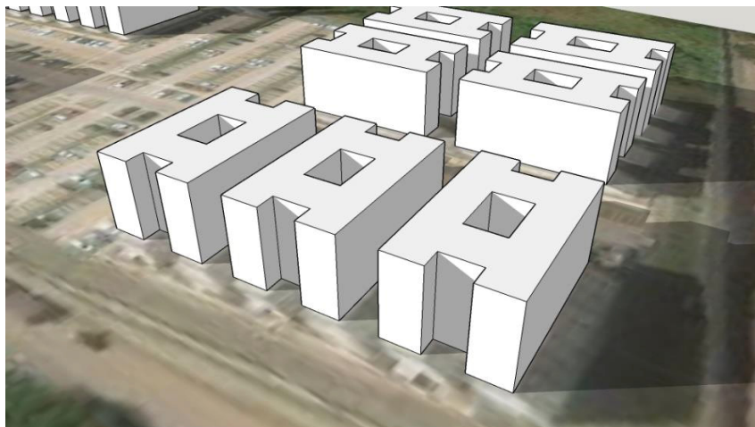
FIGURA 27 - INCIDÊNCIA SOLAR: FACHADAS NORTE-OESTE NO SOLSTÍCIO DE INVERNO 9h
