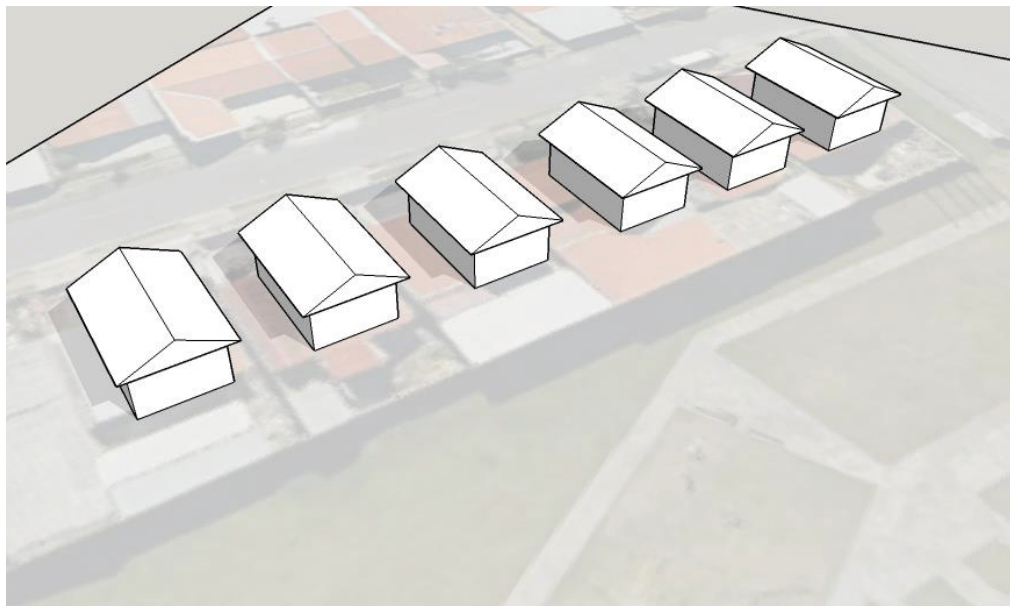
FIGURA 46 - INCIDÊNCIA SOLAR: FACHADAS SUL-LESTE NO SOLSTÍCIO DE VERÃO 9h
