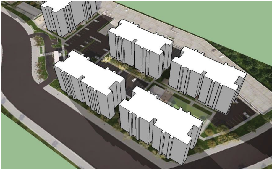
FIGURA 39 - INCIDÊNCIA SOLAR: FACHADAS SUL-LESTE NO SOLSTÍCIO DE INVERNO 15h
