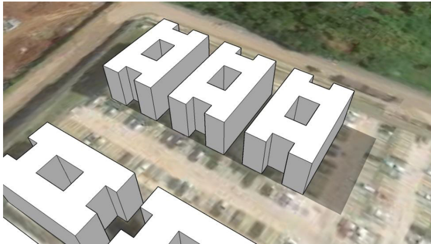
FIGURA 26 - INCIDÊNCIA SOLAR: FACHADAS SUL-LESTE NO SOLSTÍCIO DE VERÃO 15h
