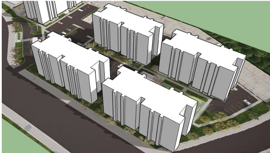
FIGURA 34 - INCIDÊNCIA SOLAR: FACHADAS SUL-LESTE NO SOLSTÍCIO DE VERÃO 9h
