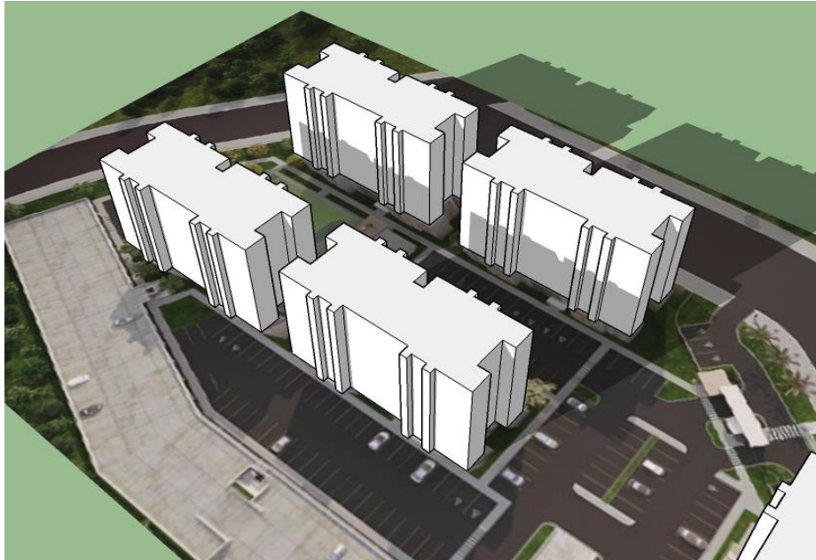
FIGURA 40 - INCIDÊNCIA SOLAR: FACHADAS NORTE-OESTE NO SOLSTÍCIO DE INVERNO 9h
