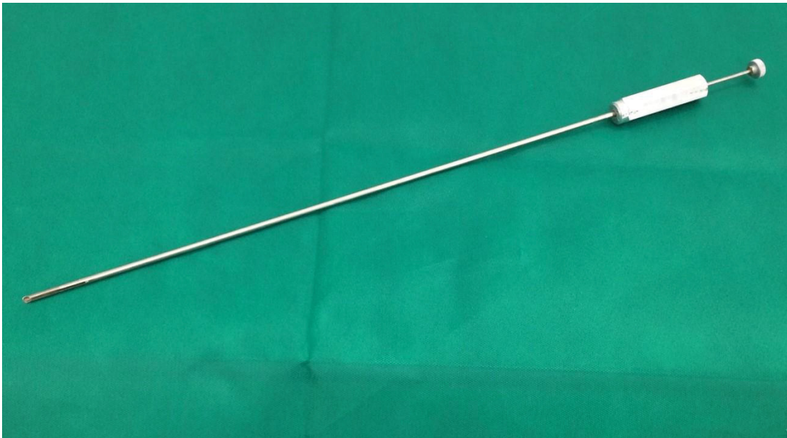
Figura 9 - Aplicador de toggle produzido em inox. Tubo vazado com recorte na ponta para encaixe do fio, com 0,5mm de espessura de parede, 50cm de comprimento e 5mm de diâmetro. Por dentro encontra-se outro cilindro em inox com 3,5mm para empurrar o toggle (Fonte: Arquivo pessoal).
