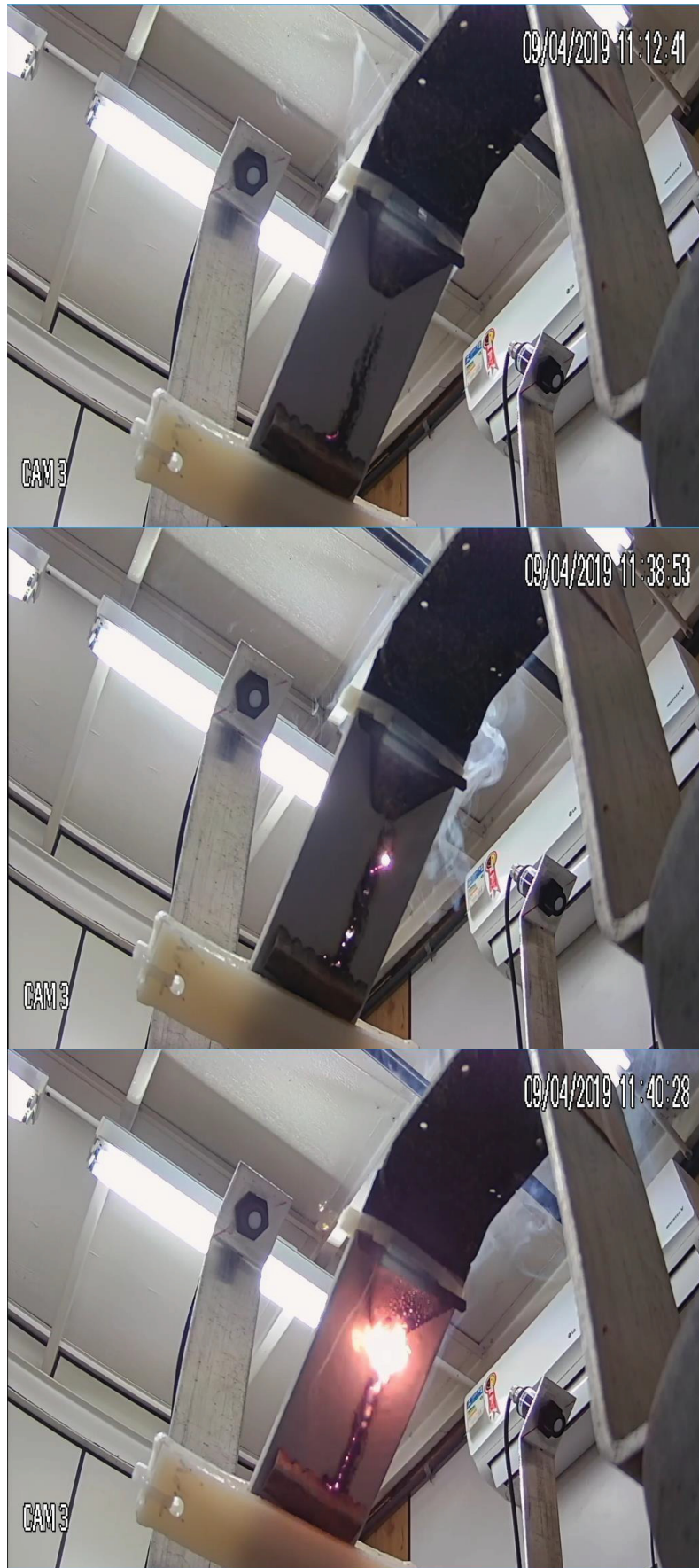
Figura 52 – Imagens da evolução do processo de trilhamento elétrico Fonte: O Autor, 2019
