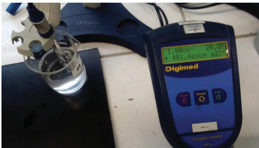
Figura 42 – Imagem do equipamento de medição da condutividade do líquido contaminante Fonte: O Autor, 2021.
