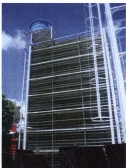
Figura 2: Primeiro fotobiorreator construído (NPDEAS)
