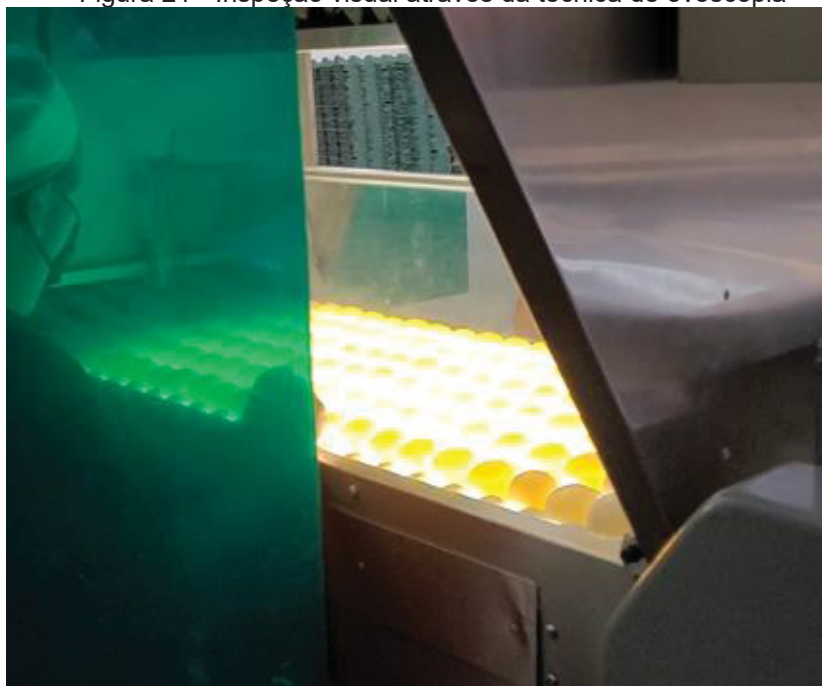
Figura 21 - Inspeção visual através da técnica de ovoscopia
