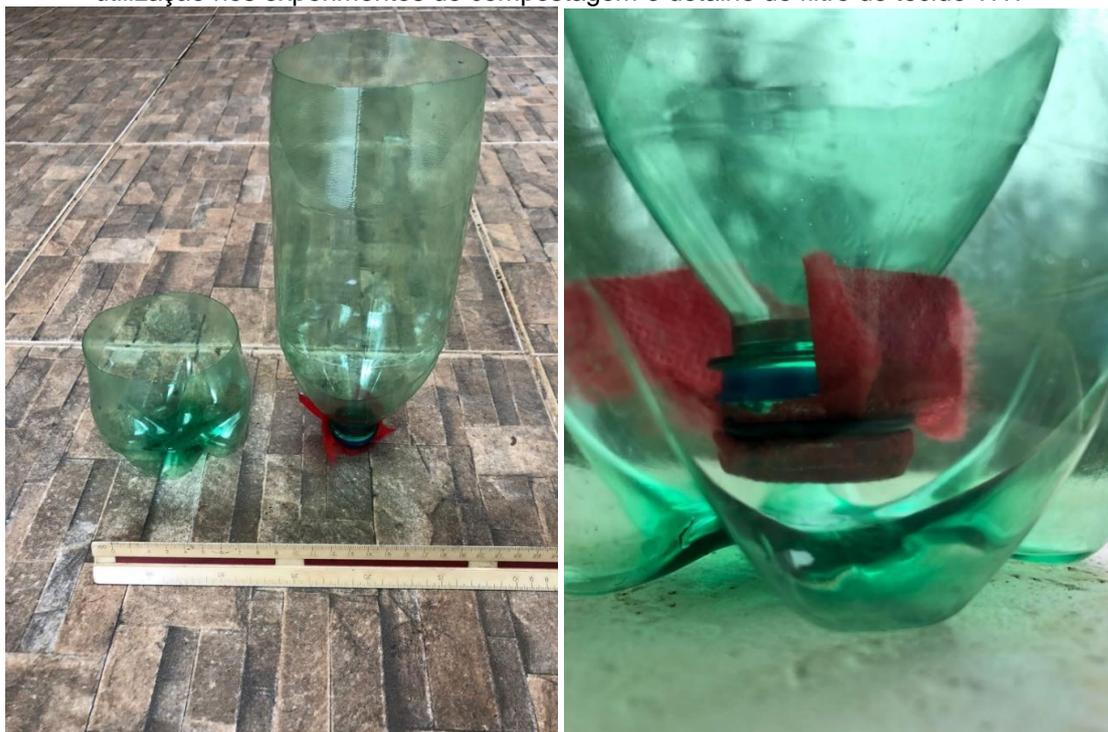
À esquerda posição de secção de garrafa PET para aproveitamento da base como coletora de lixiviado da composteira e parte da garrafa PET como recipiente para compostagem. À direita encaixe do conjunto, mostrando detalhe do espaço entre a composteira e o recipiente para evitar entupimentos.
