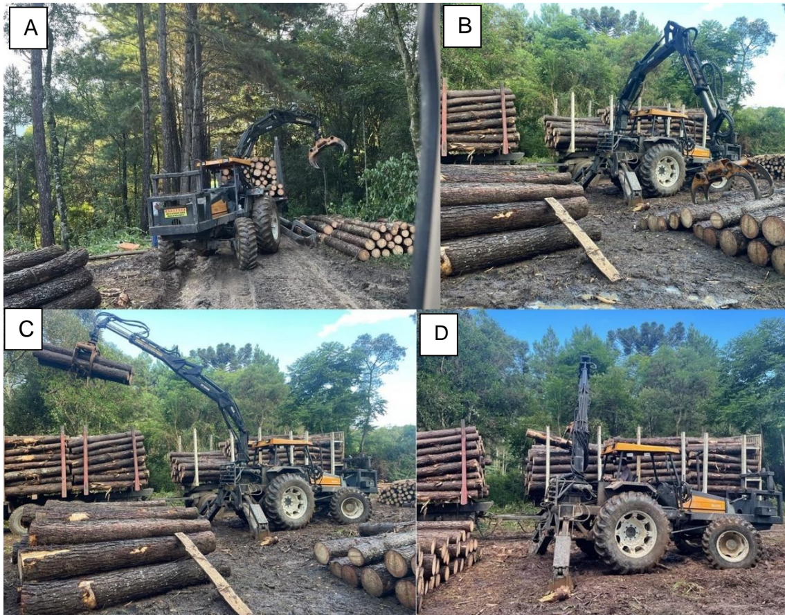
FIGURA 7 – ETAPAS DOS CICLOS DE CARREGAMENTO ANALISADOS DO CARREGADOR FLORESTAL VALTRA BM 100 IMPLMATER CF5550.
