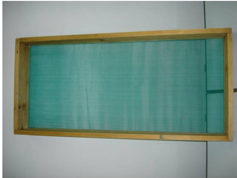
Figura 3. Fotografia ilustrativa do biorreator tipo Bandeja utilizado no estudo de escalonamento para produção de xilanase de S. virisporus T7A, por fermentação no estado sólido.
