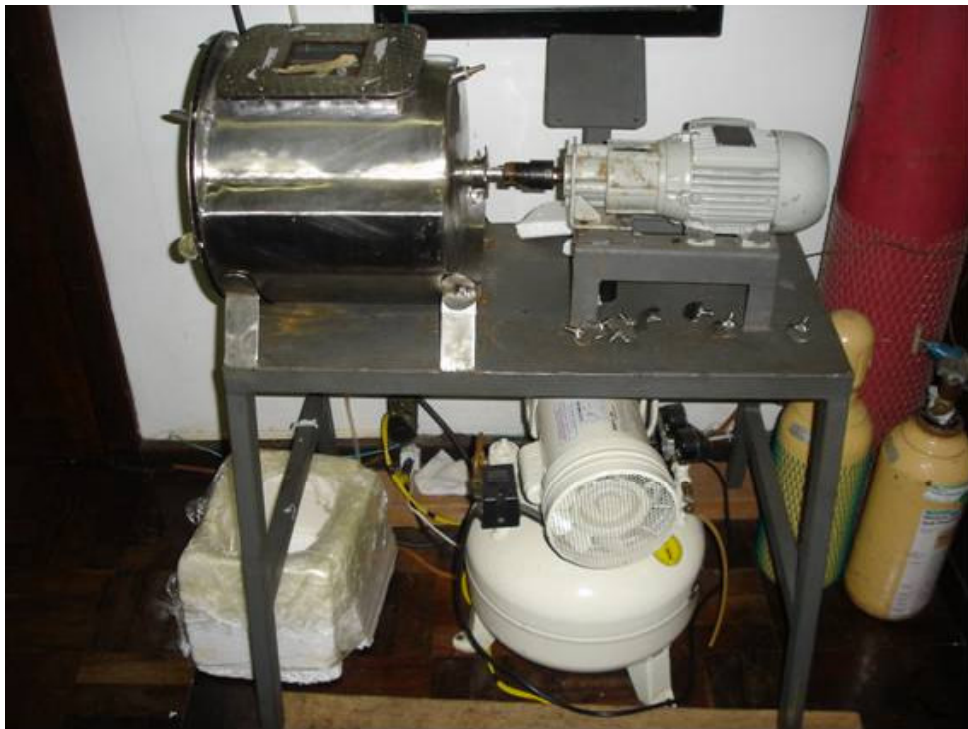
Figura 5 - Fotografia ilustrativa do biorreator tipo tambor horizontal utilizado no estudo de escalonamento para produção de xilanase de S. virisporus T7A, por fermentação no estado sólido.
