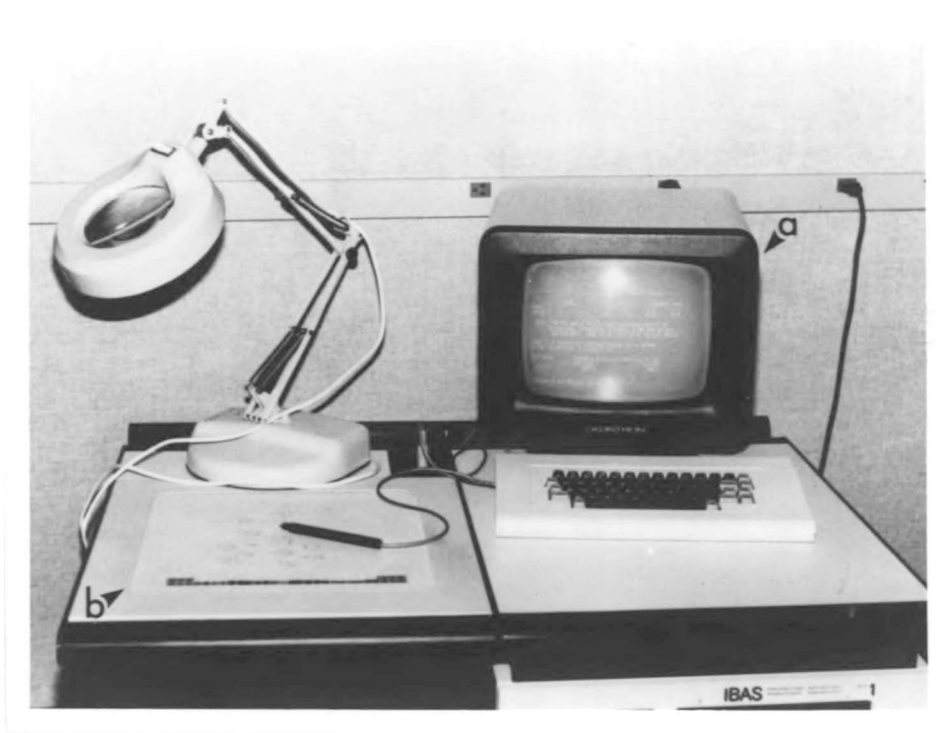
Figura 9. Aspectos do conjunto eletrônico utilizado para medição dos neurônios imunorreativos e análise dos resultados. a) Analisador de imagens IBAS ("IBAS Image Analyser"); b) Mesa magnética digital adaptada a um computador programado para analisar imagens ("IBAS Videoplan Measuring Programme").
