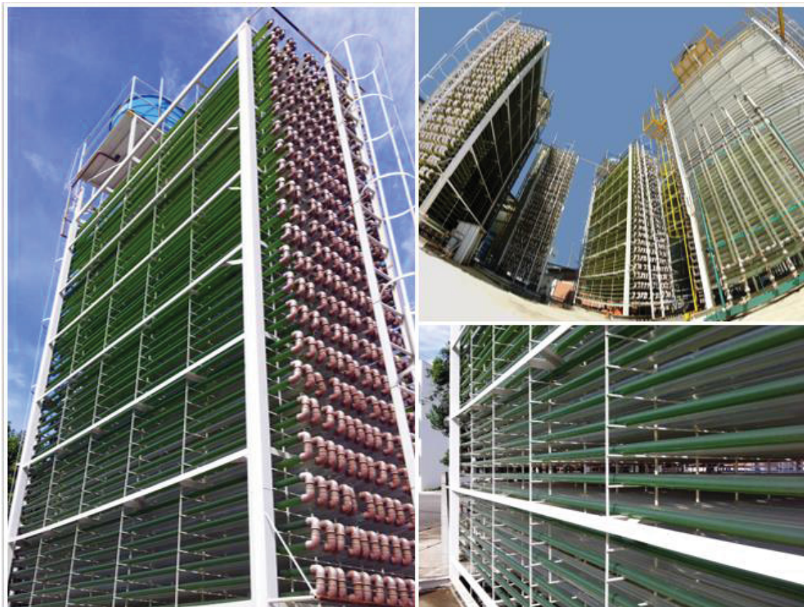
Figura 2 - Fotobiorreatores tubulares compactos de larga escala para cultivo de microalgas no NPDEAS (Curitiba, Paraná, Brasil).
