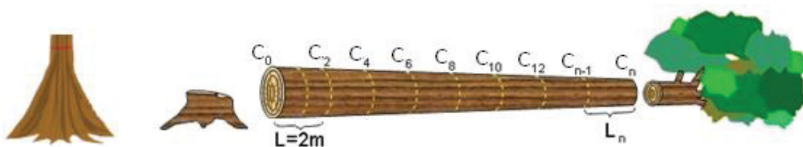
FIGURA 2 - Desenho esquemático da mensuração de uma árvore para o cálculo do volume através da fórmula de Smalian.
