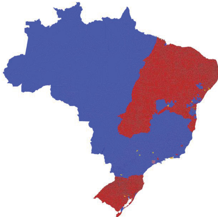
FIGURA 1 - TENSÕES ELÉTRICAS POR MUNICÍPIO NO BRASIL.
