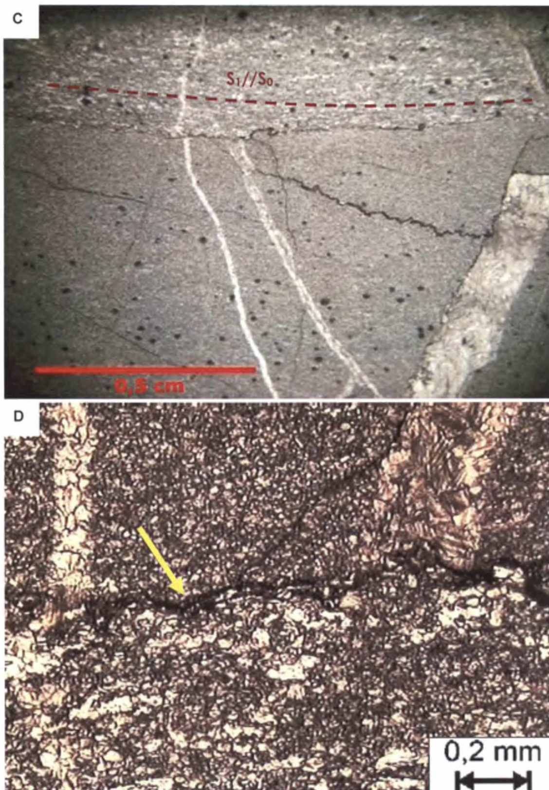
FIGURA 5 – (Cont.) – (C) Detalhe da variação granulométrica, onde se observam vênulas cortando a rocha e estilólitos marcando o contato entre os níveis mais ricos em quartzo e mica branca (granulação mais grossa) e aqueles mais ricos em carbonatos (granulação mais fina).N//. (D) Variação entre os níveis nas metamargas e o contato entre os mesmos marcado por estilólito de baixa amplitude (seta). NX
