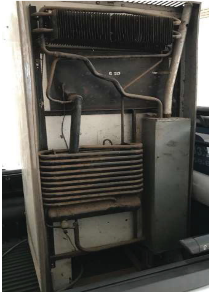
Figura 6: Geladeira Consul, refrigerador de absorção por difusão com fonte de calor a gás GLP.
