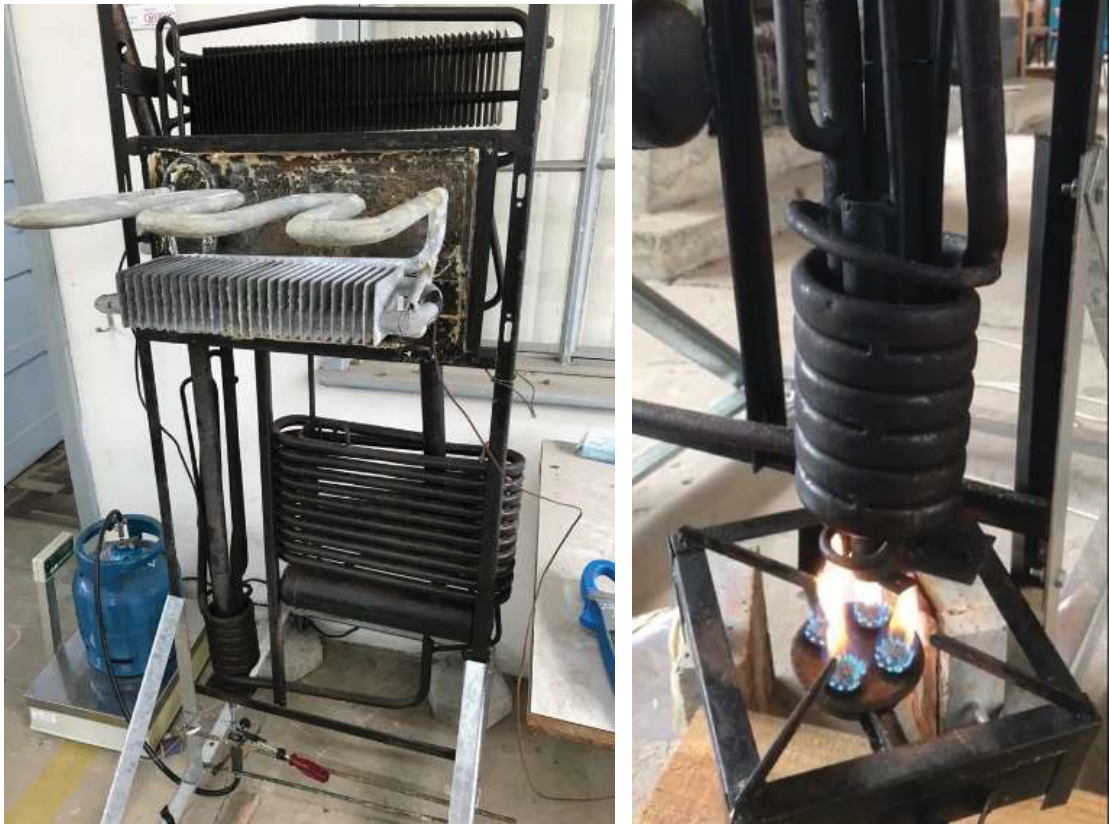
Figura 7: Experimento de verificação de funcionamento com a tocha sobre o gerador.
