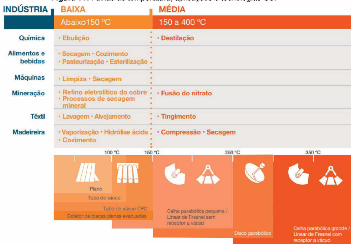
Figura 11: Faixas de temperatura, aplicações e tecnologias CSP
