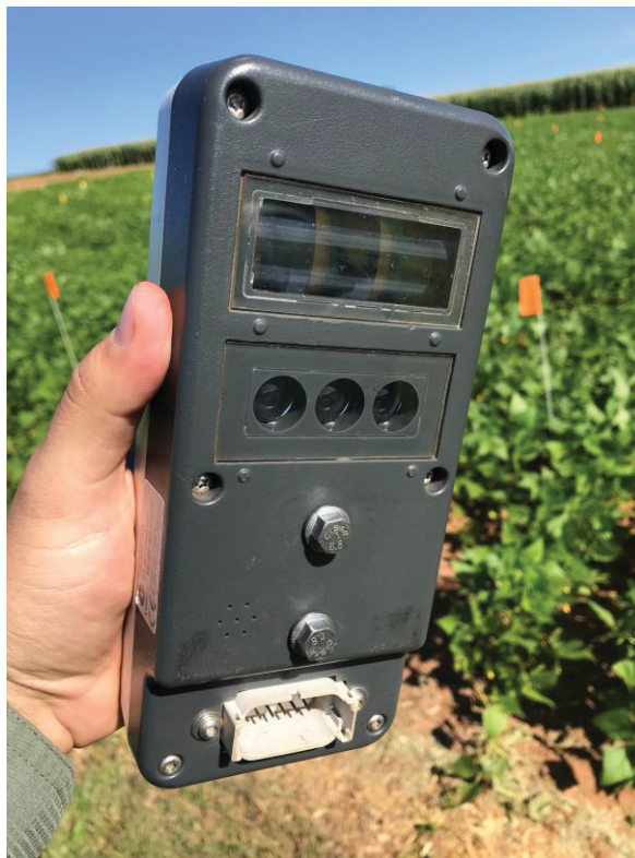
FIGURA 3 – SENSOR ÓPTICO ATIVO OTMIS GS 6200 - JACTO
