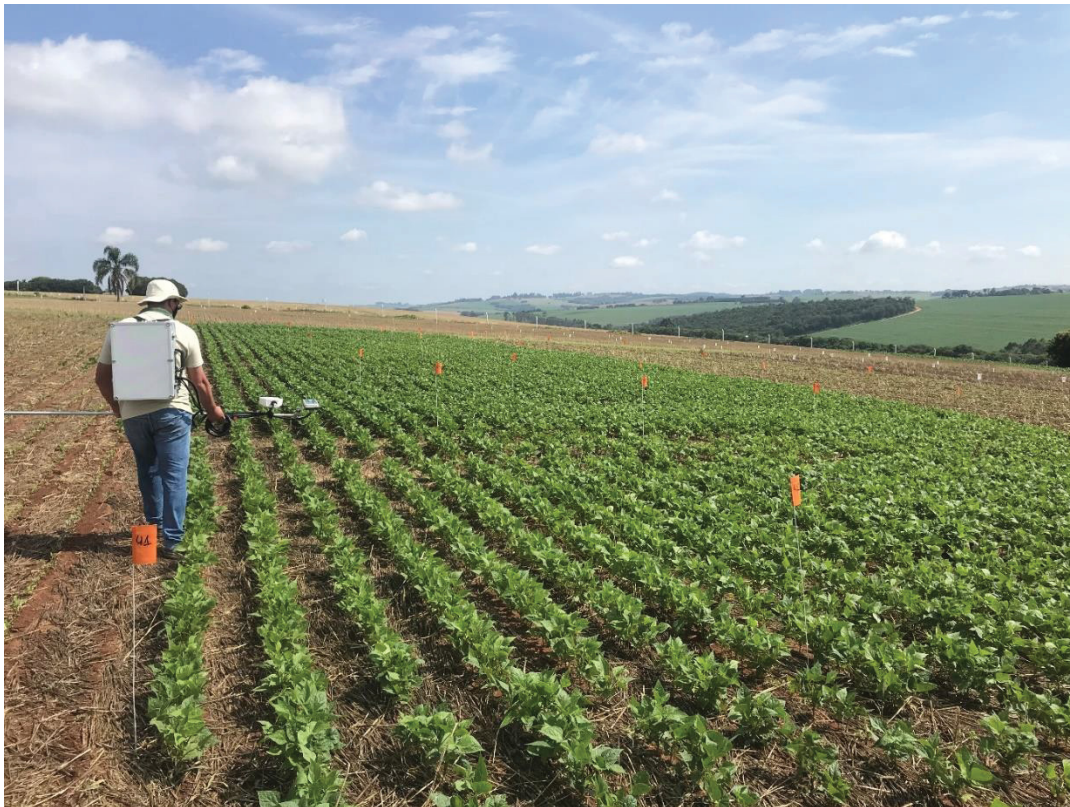
FIGURA 2 - LEITURA COM SENSOR ÓPTICO ATIVO NO ESTÁDIO FENOLÓGICO V7 DO FEIJOEIRO
