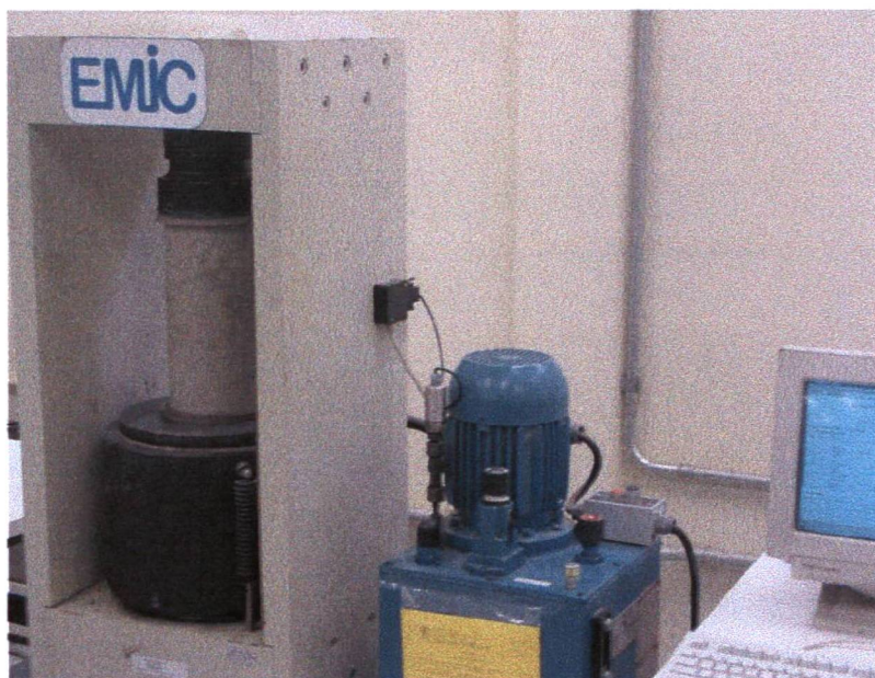
FIGURA – 3.2 PRENSA E SISTEMA DE AQUISIÇÃO DE DADOS PARA DETERMINAÇÃO DA RESISTÊNCIA À TRAÇÃO POR COMPRESSÃO DIAMETRAL.
