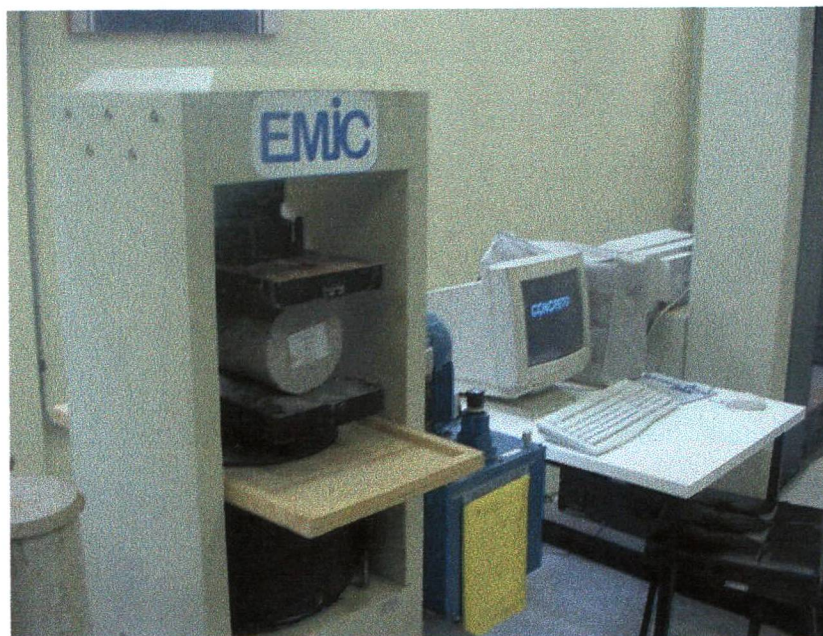
FIGURA – 3.3 PRENSA E SISTEMA DE AQUISIÇÃO DE DADOS PARA DETERMINAÇÃO DA RESISTÊNCIA À TRAÇÃO POR COMPRESSÃO DIAMETRAL
