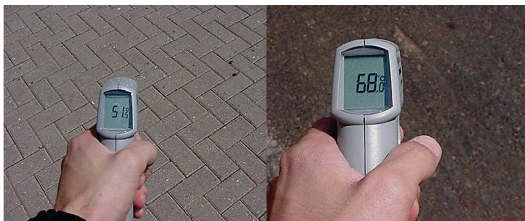
Figura 20 - Medição de temperatura no pavimento
