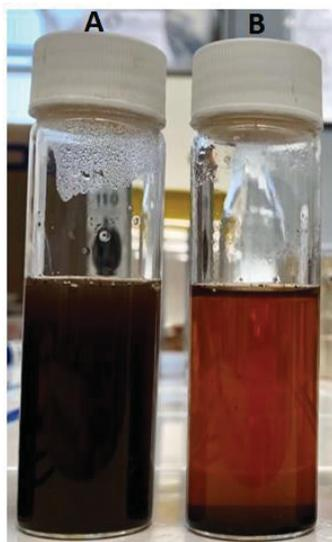
A FIGURA 16 apresenta a diferença na coloração dos controles de reação que foram realizados em reator de micro-ondas (A) e em forno mufla (B) para a conversão da frutose. É possível observar que a coloração das reações que foram realizadas em reator de aço inoxidável em forno mufla, na ausência de catalisador, apresentam coloração mais escura devido à presença de maior quantidade de produtos de degradação (huminas).
