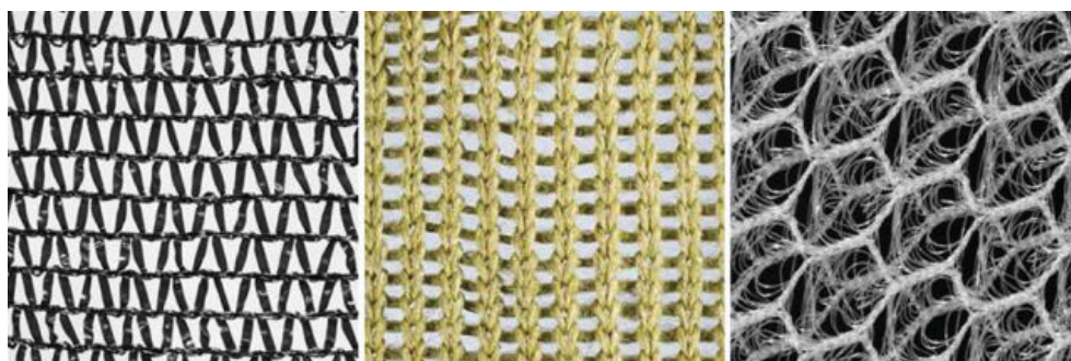
FIGURA 5 – TRÊS TIPOS DE TRAMAS UTILIZADAS EM MALHAS DE COLETA DE NEVOEIRO
