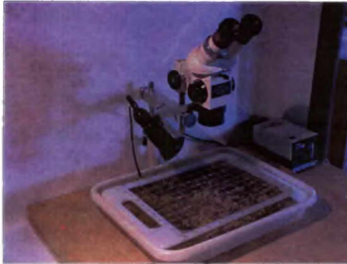
Figura 3. Microscópio estereoscópio com braço extensor, painel amostral e armação quadriculada utilizado na análise da comunidade.
