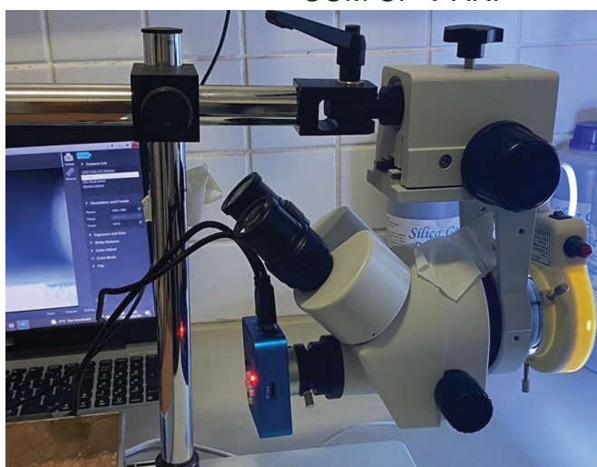
FIGURA 18 – MICROSCÓPIO ÓPTICO UTILIZADO PARA MEDIÇÃO DO ÂNGULO DE CONTATO DE UMA GOTA DE SOLUÇÃO DE SILICATO DE SÓDIO ALCALINO COM E SEM TENSOATIVO E AMOSTRA DE CONCRETO COM CP V-ARI
