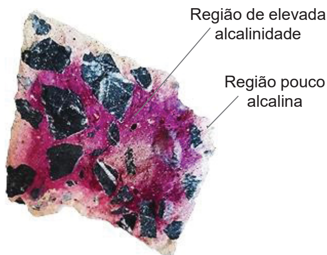
FIGURA 48 – ASPERSÃO DE FENOLFTALEÍNA NA AMOSTRA NO DIA 924, APÓS O PROCESSO DE REALCALINIZAÇÃO QUÍMICA E ALGUMAS MEDIDAS DE E_{\text{CORR}} E I_{\text{CORR}} COM A IMERSÃO POR 24H EM ÁGUA
