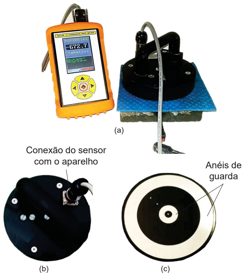
FIGURA 44 – (A) EQUIPAMENTO GECOR 10 UTILIZADO PARA MEDIÇÃO DE PARÂMETROS ELETROQUÍMICOS, (B) CONEXÃO ENTRE O EQUIPAMENTO E O SENSOR E (C) SENSOR DO EQUIPAMENTO GECOR 10
