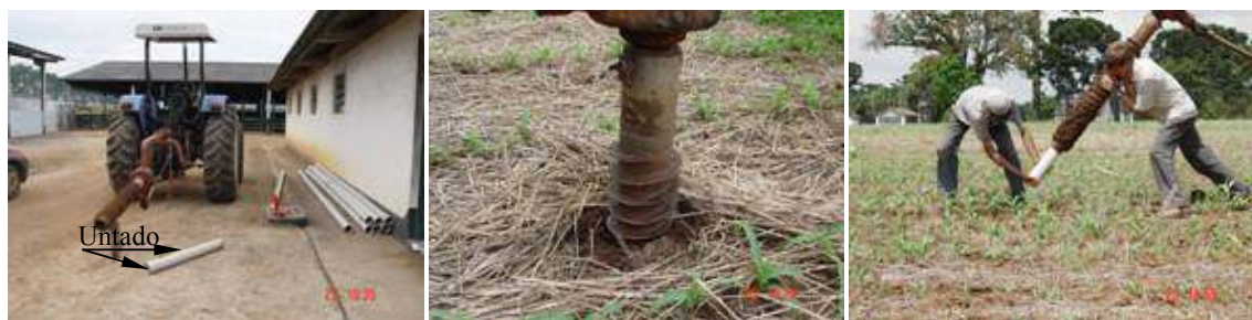
FOTO 1 - PREPARO DO TUBO DE PVC PARA INSERÇÃO NO APARELHO (ESQUERDA); APARELHO COLETANDO SOLO (CENTRO); TUBO DE PVC SENDO RETIRADO DO APARELHO APÓS COLETA DE SOLO (DIREITA)
