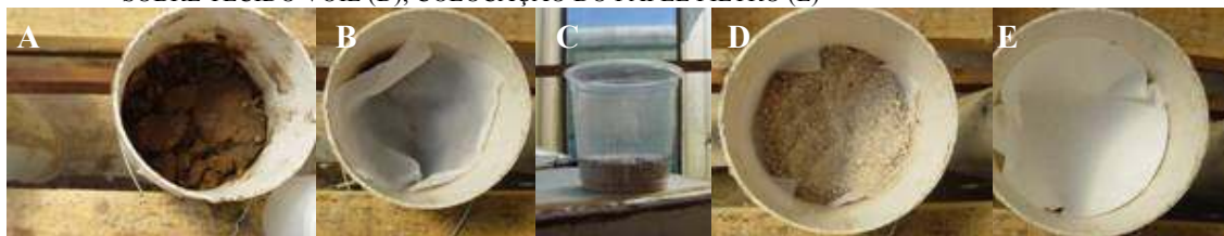
FOTO 2 - PREPARAÇÃO DA PARTE SUPERIOR DAS COLUNAS ANTES DA APLICAÇÃO DOS TRATAMENTOS: ADIÇÃO DE PARAFINA (A); COLOCAÇÃO DO TECIDO VOIL (B); MEDIDA DE AREIA (C); AREIA SOBRE TECIDO VOIL (D); COLOCAÇÃO DO PAPEL FILTRO (E)
