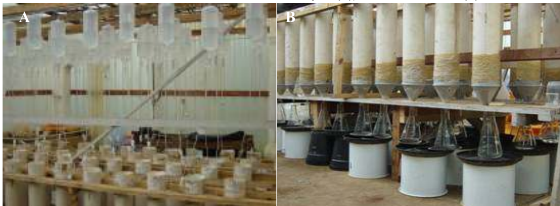
FOTO 3 - VISÃO DO EXPERIMENTO: INÍCIO DA LIXIVIAÇÃO (A); COLETA DA ÁGUA (B)
