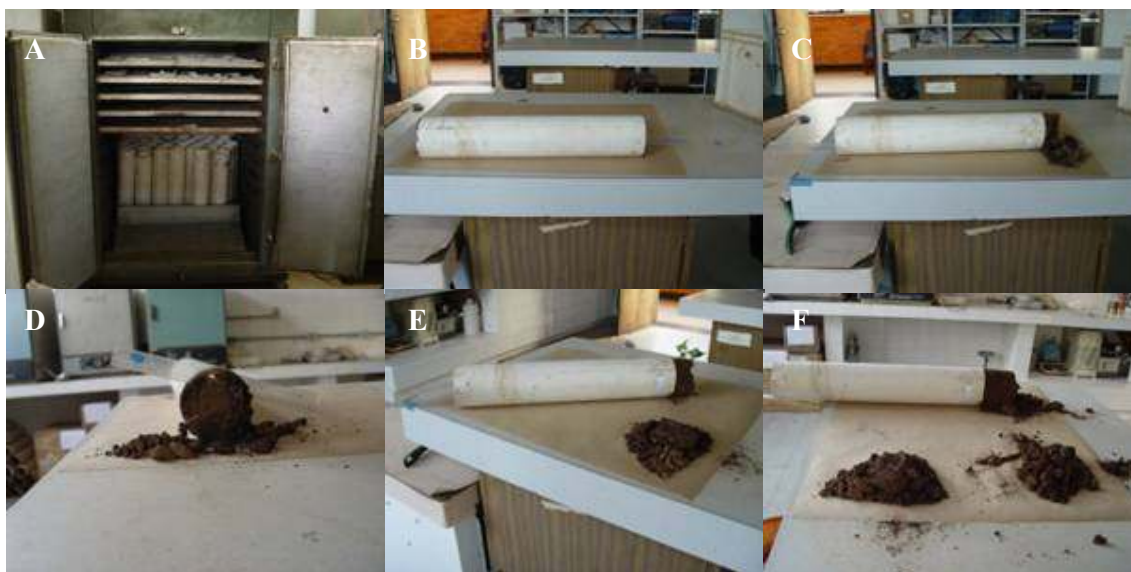
FOTO 4 - PROCEDIMENTO DE MOVIMENTAÇÃO DO SOLO DA COLUNA DE PVC: SECAGEM EM ESTUFA (A); MEDIÇÃO DO VÃO SUPERIOR (B); MEDIÇÃO APÓS DESLOCAMENTO PARCIAL PARA OBTENÇÃO DA PRIMEIRA FRAÇÃO DA COLUNA – 0 a 5 cm (C); CORTE DA FRAÇÃO – 0 a 5 cm (D); MEDIÇÃO PARA FRAÇÃO – 5 a 10 cm (E); MEDIÇÃO PARA FRAÇÃO – 10 a 20 cm (F)
