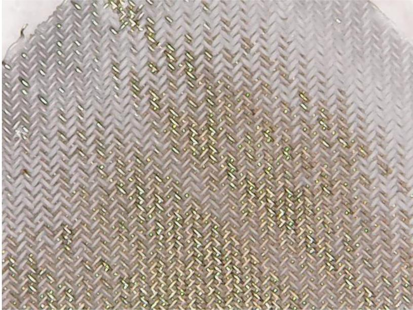
FIGURA A 12. IMAGEM OBTIDA COM MICROSCÓPIO PORTÁTIL DA DEPOSIÇÃO DE ZnO MODIFICADO COM 1% DE COBRE
