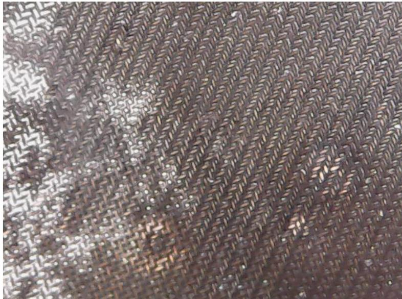
FIGURA A 13. IMAGEM DE MICROSCOPIA ELETRÔNICA DE VARREDURA DA MALHA DE AÇO DEPOSITADA COM ZnO E POSTERIORMENTE COBRE POR 120s
