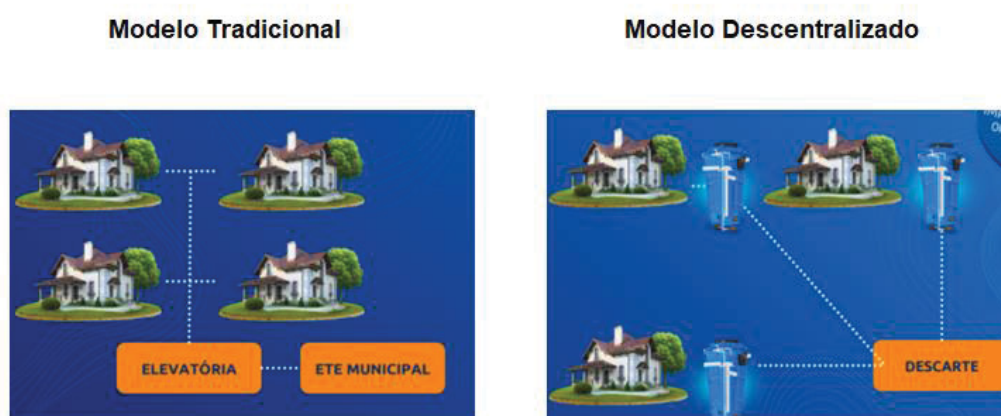
FIGURA 16 – ESTAÇÃO DE TRATAMENTO TRADICIONAL E DESCENTRALIZADO
