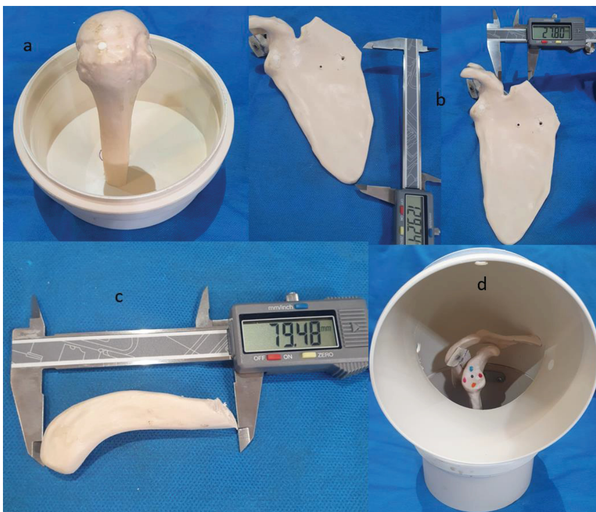
FIGURA 3 – Cortes e fixações a) fixação do úmero na tampa; b) corte da escápula, furo para fixação e ponto de fixação na estrutura externa; c) clavícula cortada; d) montagem interna
