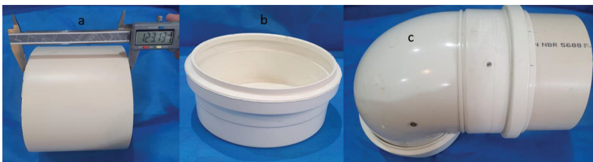
FIGURA 2 – a) Tubo de conexão a); b)CAP PVC; c) Cano joelho PVC com tubo de conexão.
