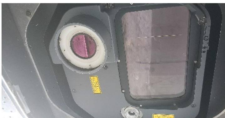
FIGURA 5 - SISTEMA ÓPTICO-MECÂNICO DE VARREDURA LASER
