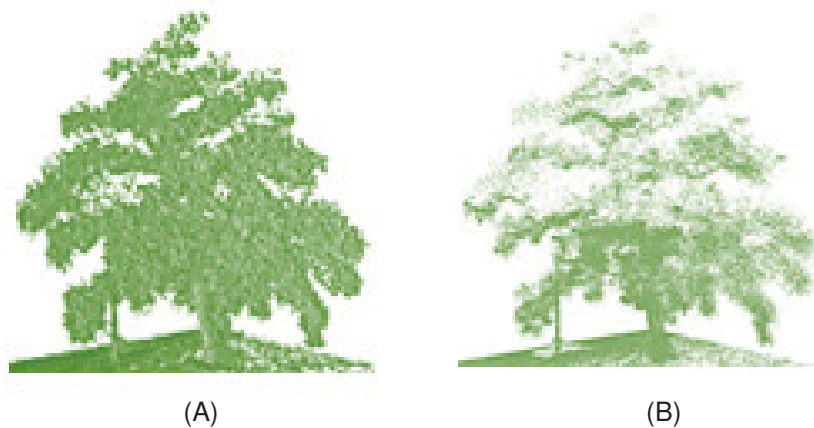
FIGURA 23 – SIMPLIFICAÇÃO 3D DE ÁRVORE INDIVIDUAL: (A) REPRESENTAÇÃO ORIGINAL; (B) REPRESENTAÇÃO SIMPLIFICADA.
