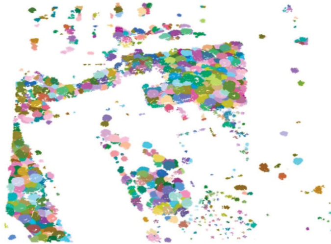
FIGURA 50 - RESULTADO VISUAL DA SEGMENTAÇÃO DE ÁRVORES NOS DADOS ALS (VISUALIZAÇÃO EM CORES POR ID)
