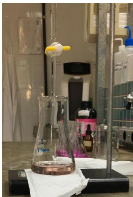
FIGURA 6: TITULAÇÃO DAS AMOSTRAS DE ETANOL.
