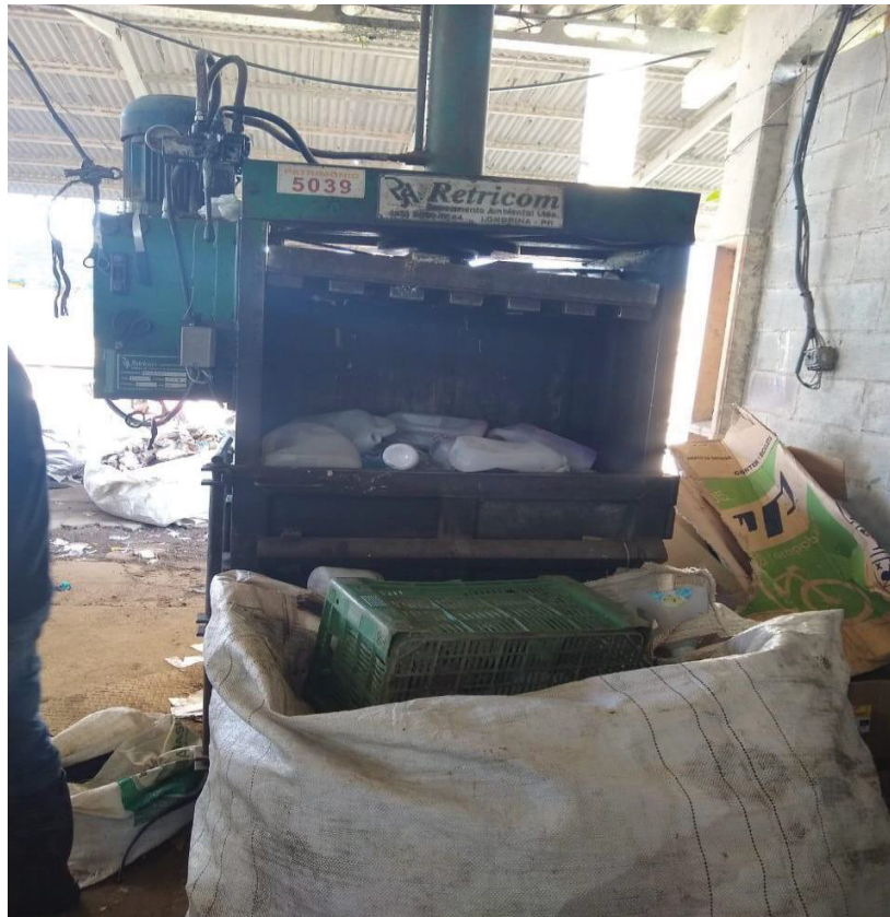
FIGURA 05 – Prensa utilizada para compactar os materiais
