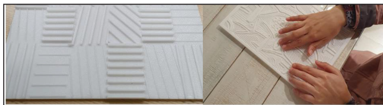
FIGURA 32 - PROTÓTIPOS DE ARTE COM TACTILE-COLOR TEXTURE IMPRESSOS EM 3D
