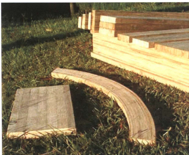
FIGURA 9 - VIGAS E TÁBUAS DE BAMBU
