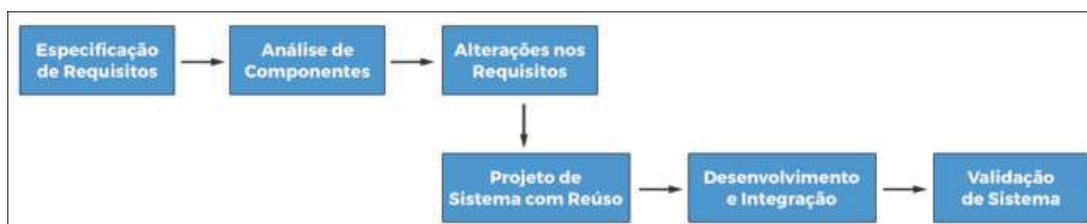
FIGURA 8 – Engenharia de software orientada a reuso
