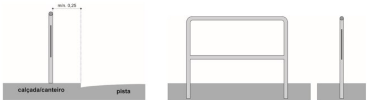
Figura 28 - Detalhamento do gradil
