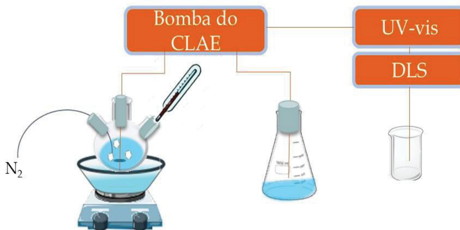
FIGURA 8 CONFIGURAÇÃO DO SISTEMA ACOMP PARA SISTEMAS TRIDIMENSIONAIS A SEREM APLICADOS NA MONITORAÇÃO EM TEMPO REAL DO PROCESSO DE SÍNTESE DE NANOCÁPSULAS REVESTIDAS COM PAA. FONTE: SCARIOTI ET AL., 2011
