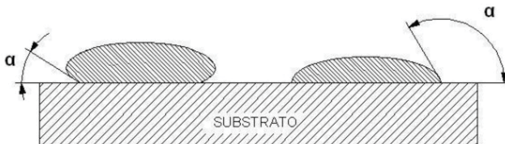
FIGURA 4- ILUSTRAÇÃO DAS INFLUÊNCIAS DOS ÂNGULOS ALFA DAS PARTÍCULAS DEPOSITADAS EM REFERÊNCIA AO EFEITO MOLHAMENTO
