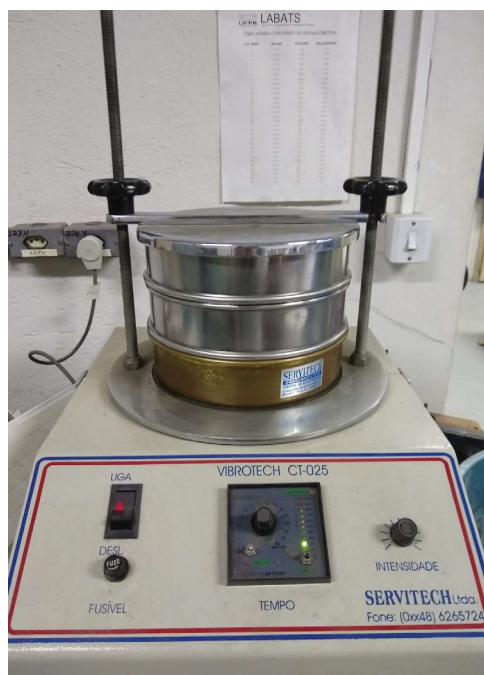
FIGURA 23 - EQUIPAMENTO VIBRATÓRIO DE SEPARAÇÃO DOS PÓS POR FAIXA DE GRANULOMETRIA
