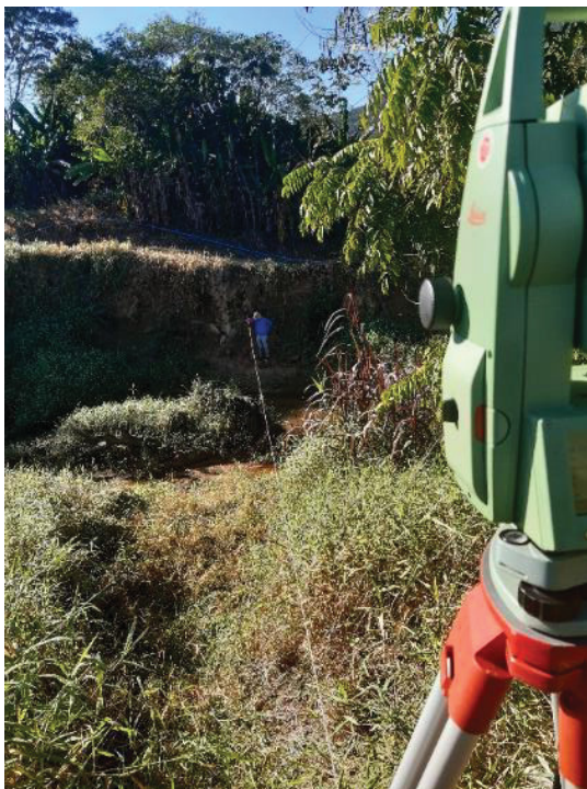
Figura 19 Levantamento topográfico de seção transversal, seção 04
