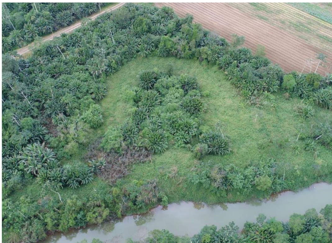
Figura 57 Identificação de feição meândrica abandonada pelo rio Jacareí, em decorrência de obras de retificação do canal principal
