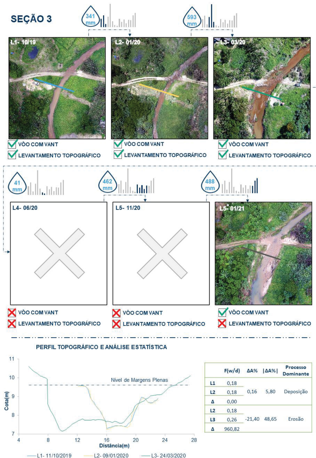
Figura 53 Resumo da análise da geometria hidráulica da seção 03. Onde L1, L2 e L3 correspondem aos levantamentos realizados
