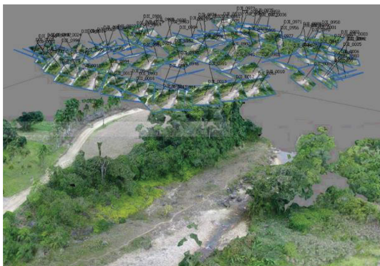
Figura 22 Modelagem tridimensional produzida a partir das imagens do VANT. Fonte: o autor (2020)
