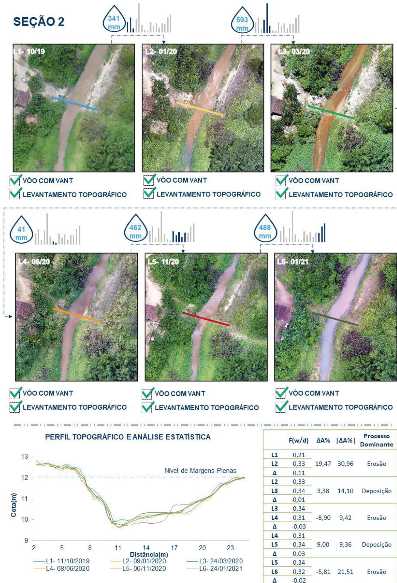
Figura 50 Resumo da análise da geometria hidráulica da seção 02. Onde L1-L6 correspondem aos levantamentos realizados
