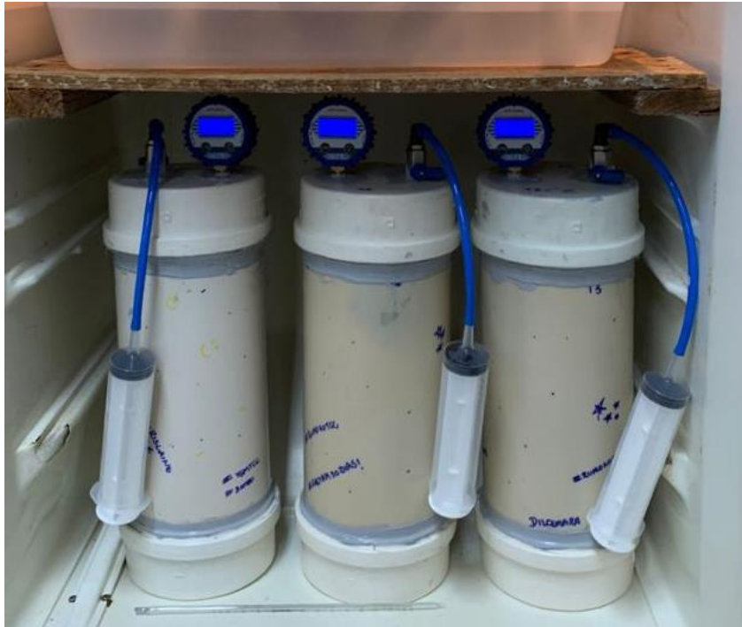
FIGURA 7 - REATORES DE DIGESTÃO ANAERÓBIA COM APARATO
