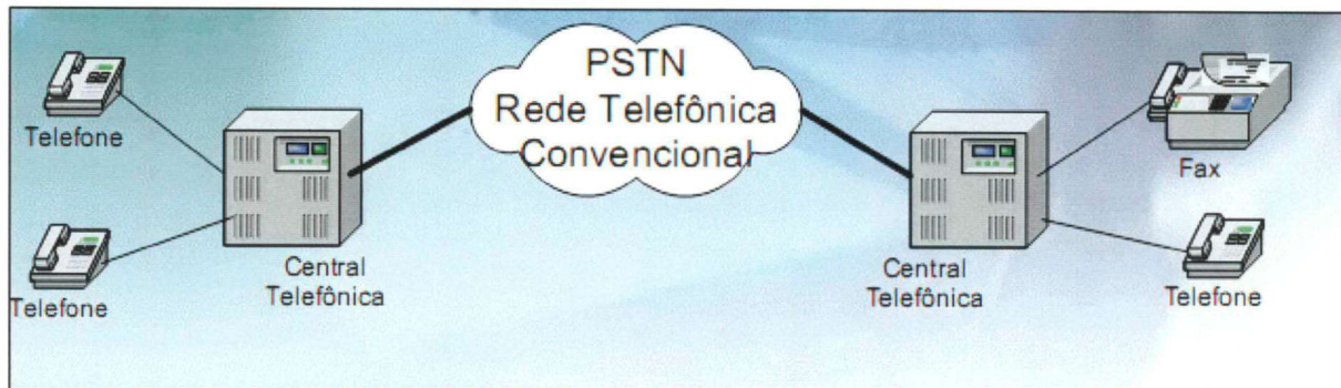
FIGURA 4 - REDE TELEFÔNICA CONVENCIONAL FONTE: LABVoIP (2007).
