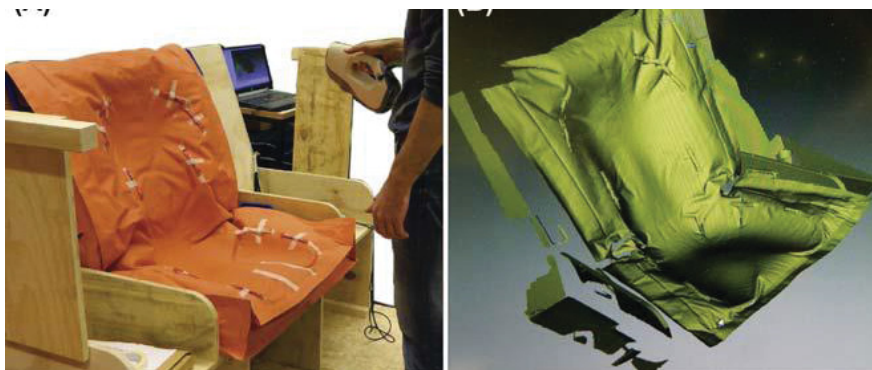
FIGURA 17 - EXEMPLO DE COLETA INDIRETA DA GEOMETRIA
